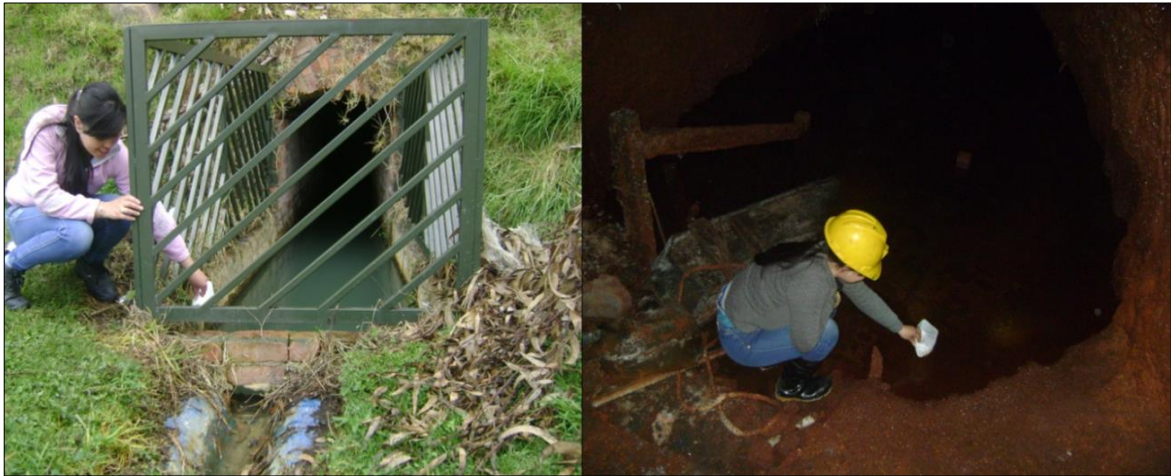
Figura 49. Recolección de muestras de agua en superficie y zonas de infiltración en labores mineras.
