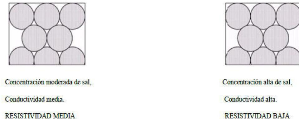
Figura 15: Relación de resistividad-conductividad con respecto a la concentración de sal. Fuente: (registros geofísicos)
