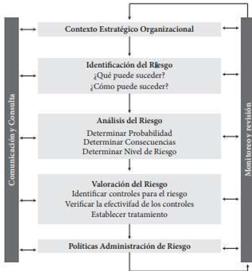
Ilustración 5: Proceso para la administración del riesgo. Guía para la administración del riesgo. DAFP
