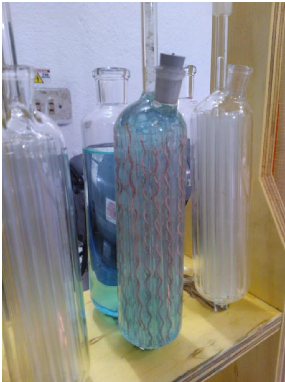
Figura 17. Aparato de Orsat con solución de ácido nítrico al 10 % utilizada para limpiar sus componentes.
