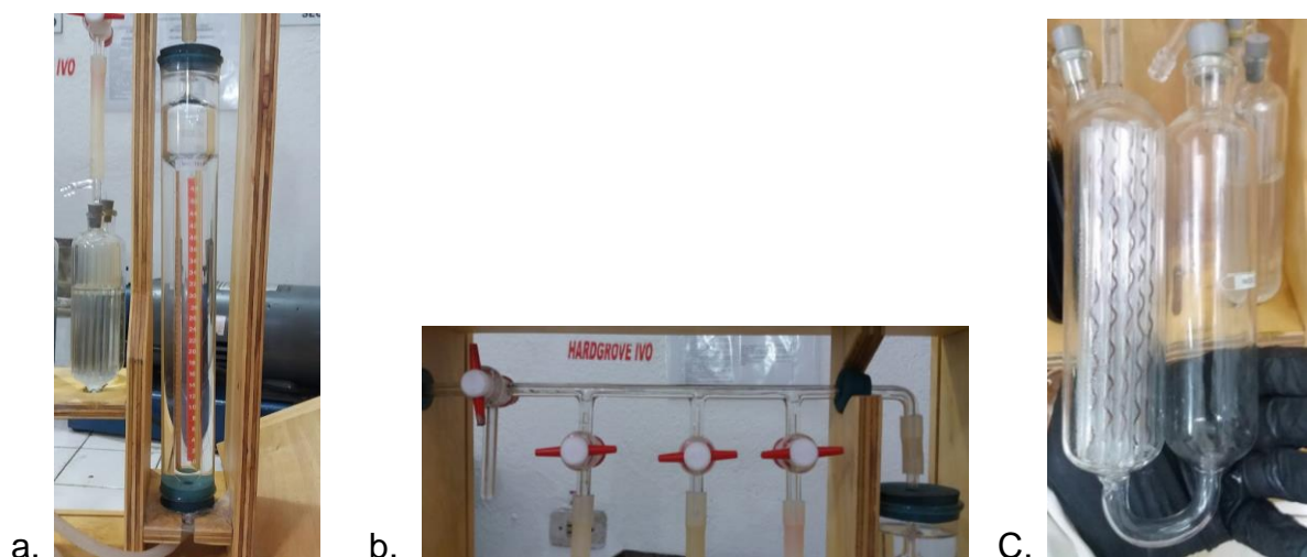
Figura 11. a. Bureta de 100ml con camisa de agua. b. llave de tres vías c. recipiente de absorción.
