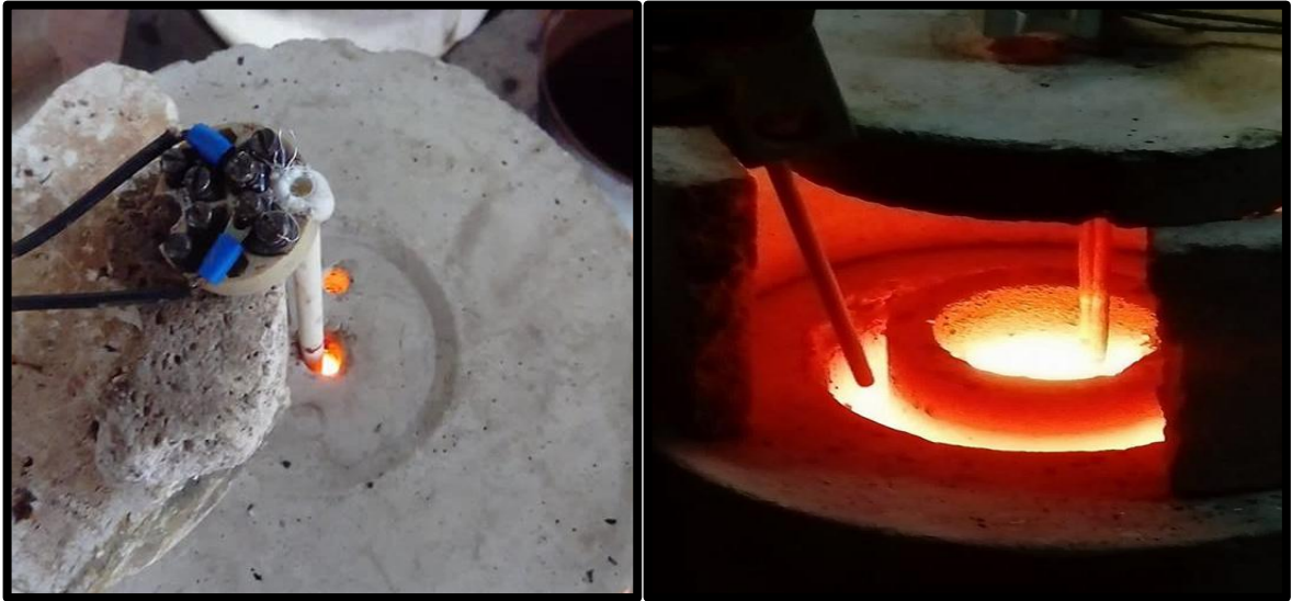
Figura 39. Termocupla tipo R e Inmersión de Electrodos de Grafito.
