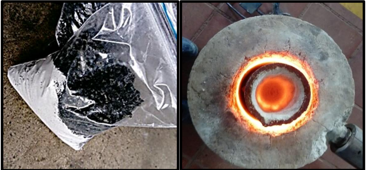
Figura 38. Mezcla de Escoria de Ferroníquel Y Alúmina para fusión y Calentamiento del crisol SiC en la bobina de trabajo del Horno de Inducción.
