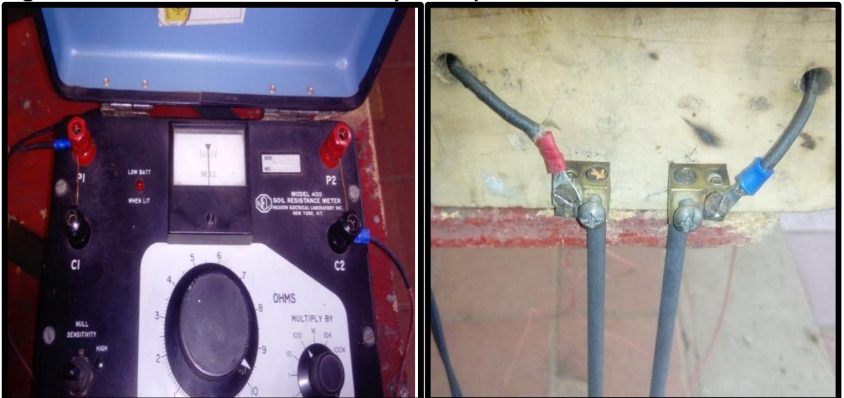
Figura 41. Medición de la Resistencia y Montaje de los Electrodo de Grafito.
