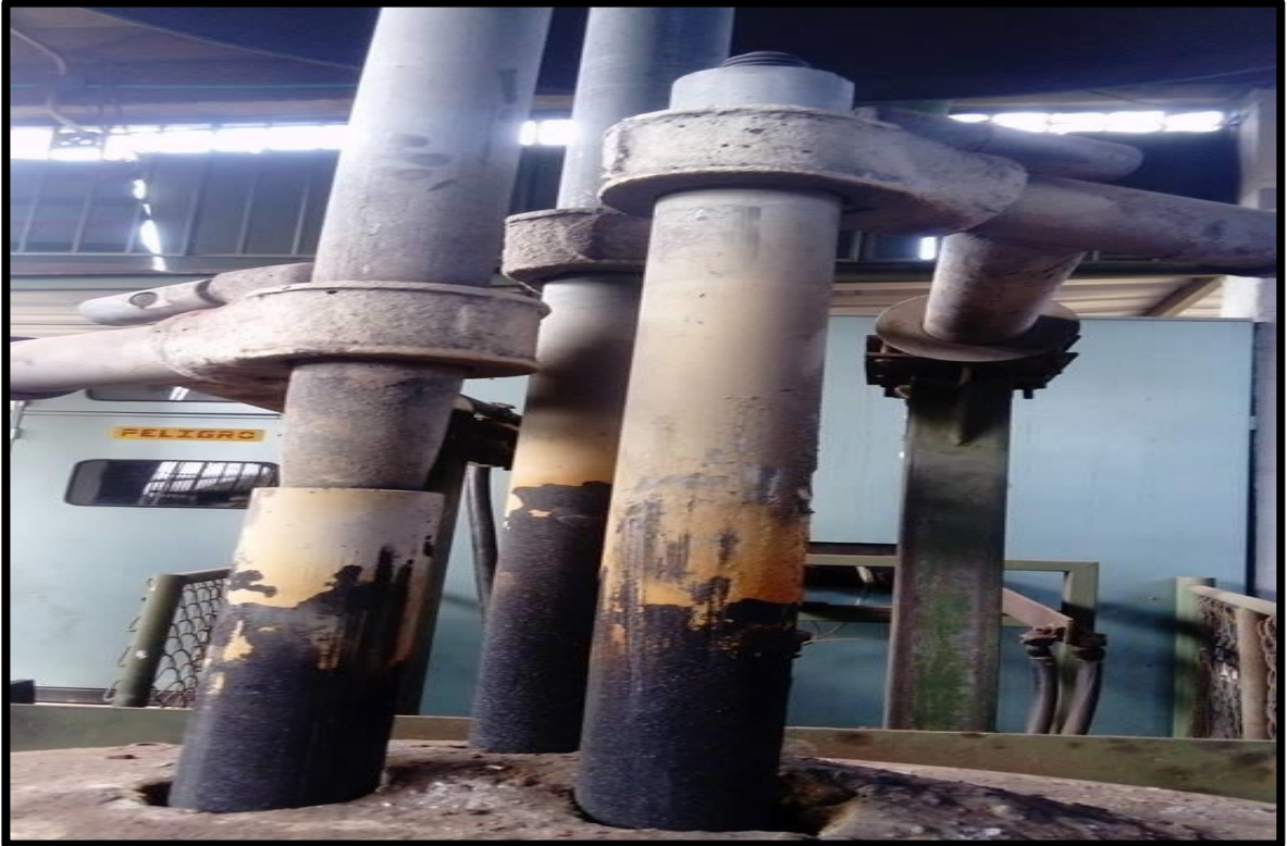
Figura 12. Conjunto de brazos porta-electrodos y Mordaza
