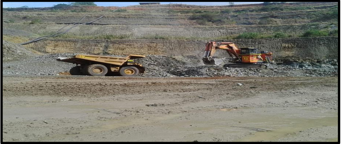
Figura 3. Frente de excavación del mineral laterítico de níquel Cerro Matoso S.A.
