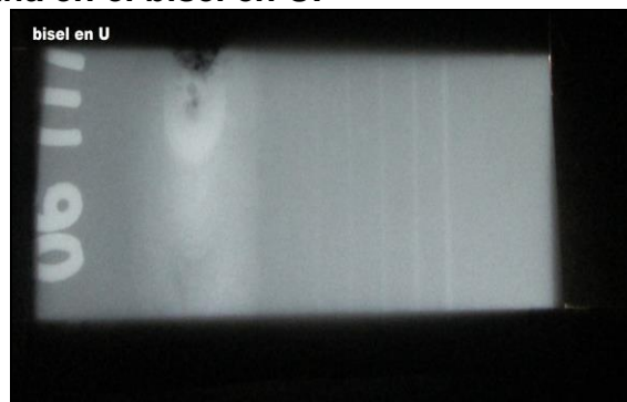
Figura 38. Radiografía en el bisel en U.
