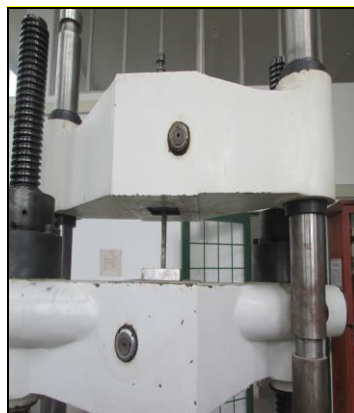
Figura 31. Posicionamiento de la probeta ensayo de tracción.
