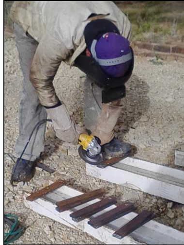
Figura 16. Preparación de las diferentes juntas.
