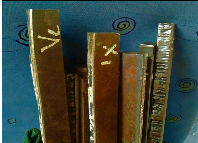
Figura 30. Probetas para ensayo de tracción.
