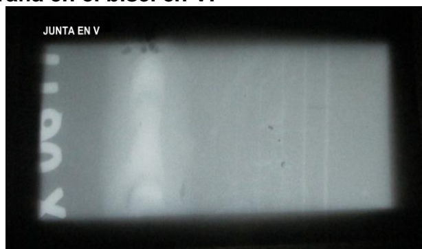
Figura 39. Radiografía en el bisel en V.
