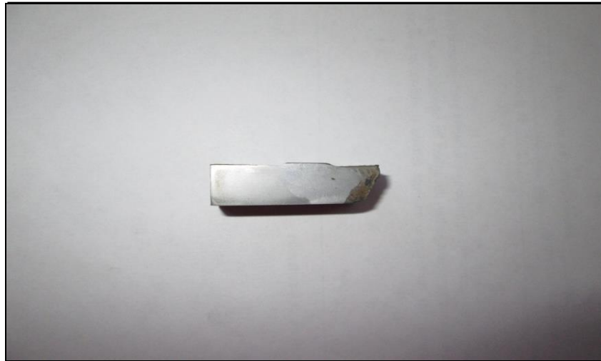
Figura 26. Probeta atacada químicamente Nital 3%.
