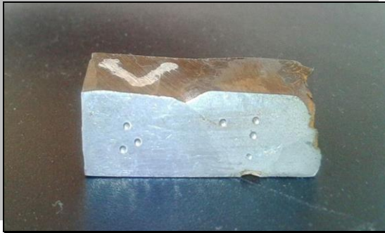
Figura 28. Probetas para ensayo de dureza.
