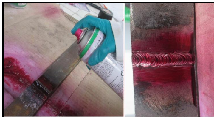
Figura 22. Aplicación del penetrante.
