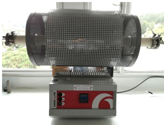
Figura 78. Horno tubular CARBOLITE SFT/TZF
