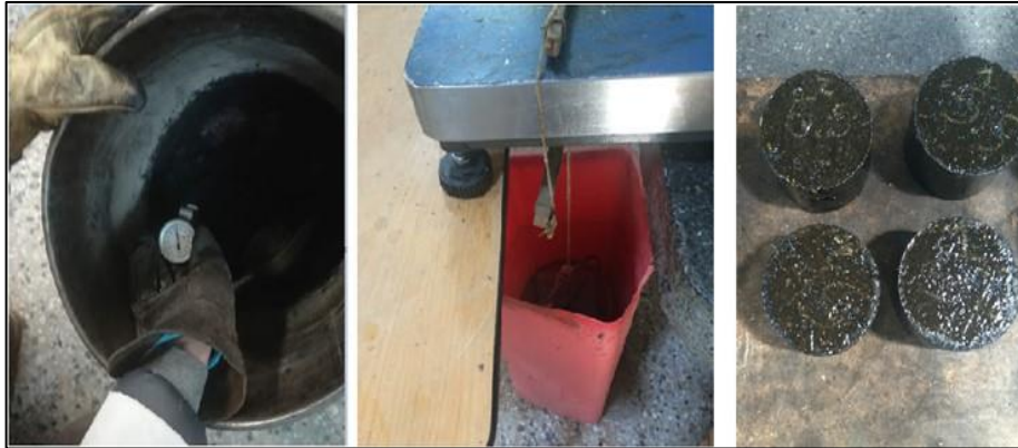
Figura 48. Determinación de la gravedad específica de los especímenes.
