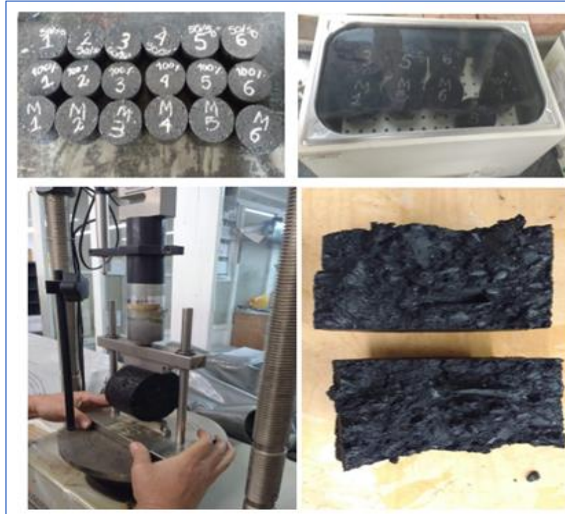
Figura 52. Equipo y resultado final para determinar la resistencia a la tensión
