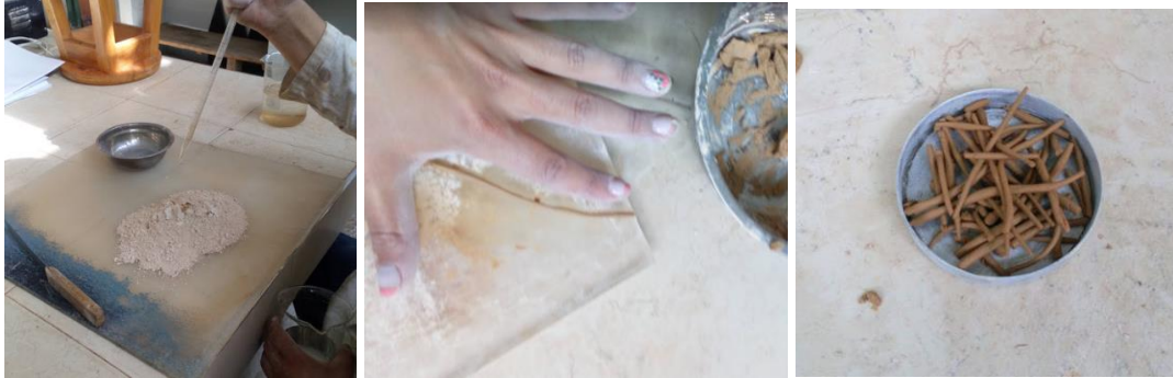
Ilustración 6. Proceso del ensayo de límite plástico. Laboratorios de materiales y estructuras Universidad Pedagógica y Tecnológica de Colombia (2019).
