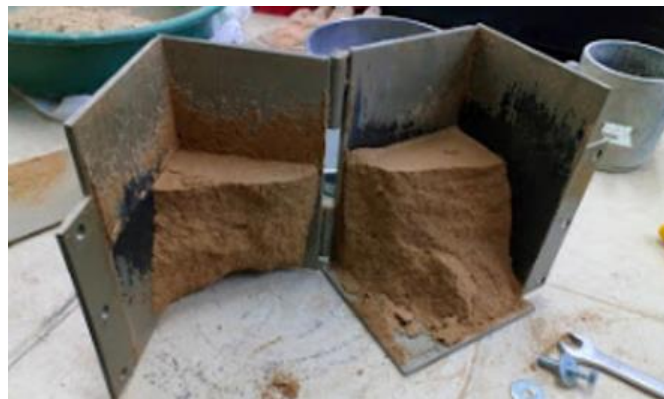
Ilustración 11. Espécimen fracturado por pandeo de láminas durante compactación en molde N°2. Laboratorios de materiales y estructuras Universidad Pedagógica y Tecnológica de Colombia (2019).
