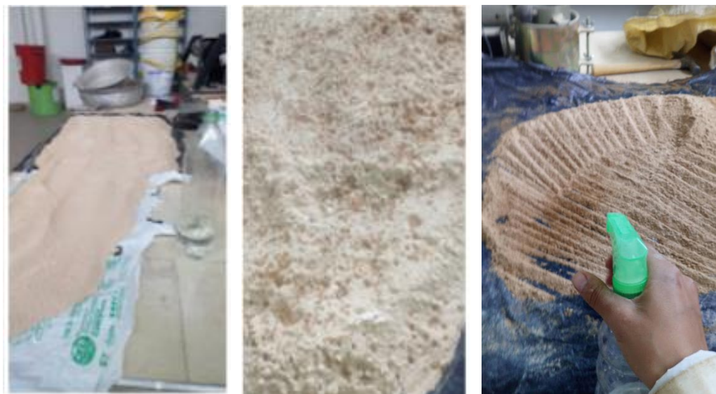
Ilustración 13. Proceso de humedecimiento y mezclado para la fabricación de especímenes. Laboratorios de materiales y estructuras Universidad Pedagógica y Tecnológica de Colombia (2019).
