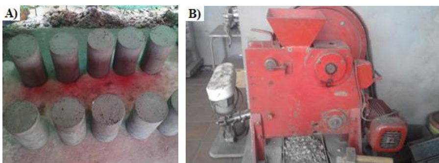
Ilustración 3. A) cilindros de concreto f'c 4000 psi. B) Trituradora de mandíbula. Laboratorios de materiales y estructuras Universidad Pedagógica y Tecnológica de Colombia (2019).
