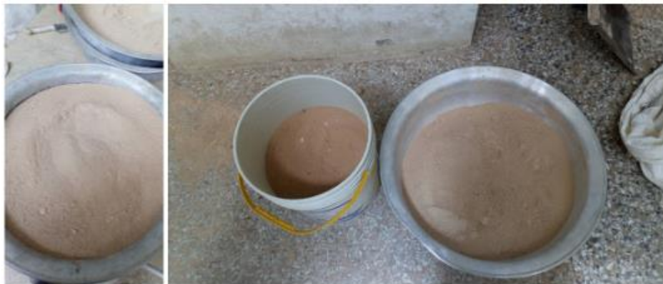
Ilustración 9. Mezcla 1, 2 y 3 posterior al mezclado con arcilla diatomea. Laboratorios de materiales y estructuras Universidad Pedagógica y Tecnológica de Colombia (2019).
