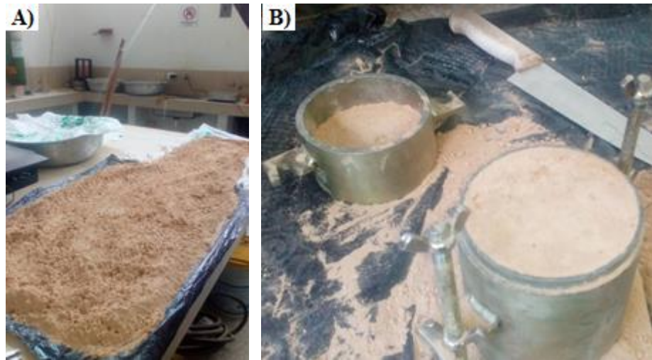
Ilustración 8. A) Adición del contenido de agua con un atomizador. B) Material enrasado a la altura del molde cilíndrico. Laboratorios de materiales y estructuras Universidad Pedagógica y Tecnológica de Colombia (2019)
