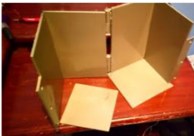
Ilustración 12. Molde N°3 recubierto internamente con pintura anticorrosiva. Elaboración propia (2019)
