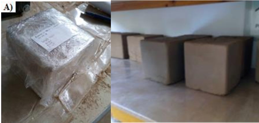
Ilustración 16. A) Recubrimiento del espécimen desencofrado con vinipel para proceso de curado 7 días. B) Proceso de curado 14 días, especímenes al aire libre protegidos del sol y la lluvia. Laboratorios de materiales y estructuras Universidad Pedagógica y Tecnológica de Colombia (2019).
