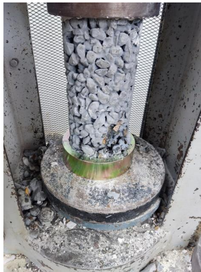
Ilustración 2. Montaje ensayo de resistencia a compresión. Fuente: Autor.
