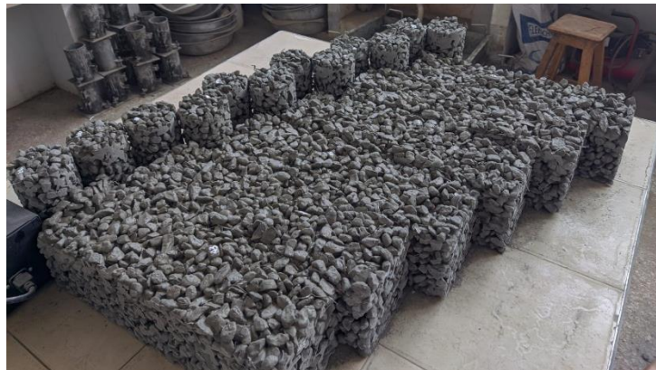
Ilustración 12. Especímenes de vigas y cilindros. Fuente: Autor.
