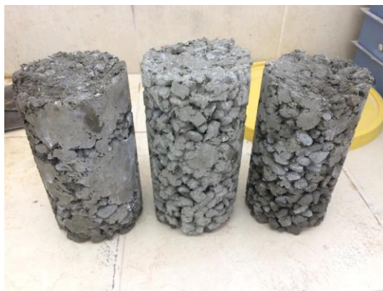
Ilustración 7. Cilindros con diferentes porcentajes de agregado fino. Fuente: Autor.
