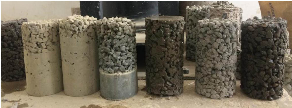
Ilustración 8. Cilindros con diferentes dosificaciones de aditivos. Fuente: Autor.
