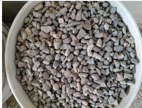
Ilustración 3. Agregado grueso mono tamaño de fuente aluvial. Fuente: Autor.
