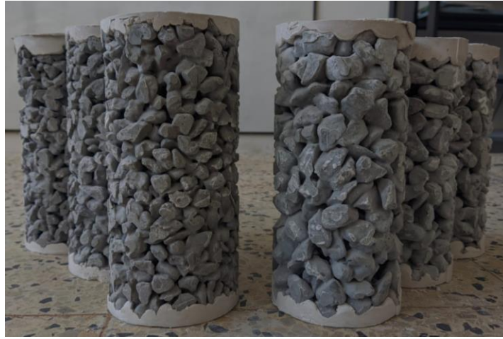
Ilustración 4. Cilindros con diferente tamaño de agregado grueso (3/8" y 1/2").
