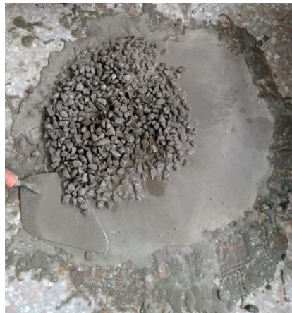
Ilustración 18. Mezcla con exceso de agua y aditivo. Fuente: Autor.
