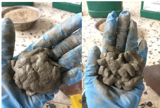
Ilustración 9. Mezcla con y sin aditivo reductor de agua. Fuente: Autor.
