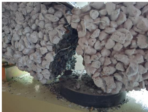
Ilustración 17. Contenido de Fibras en una viga de concreto permeable. Fuente: Autor.
