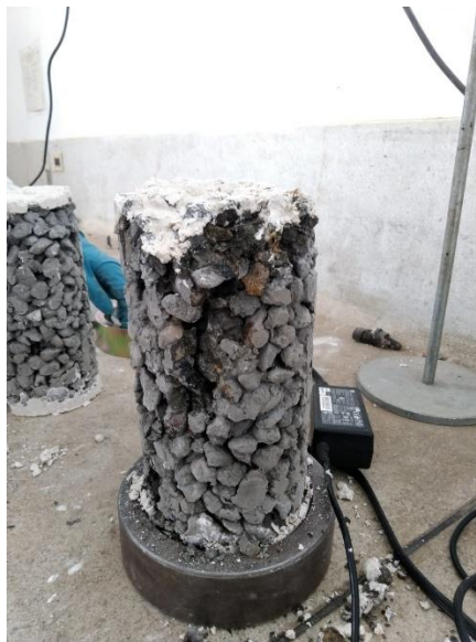
Ilustración 20. Espécimen con Agregado de rio. Fuente: Autor.
