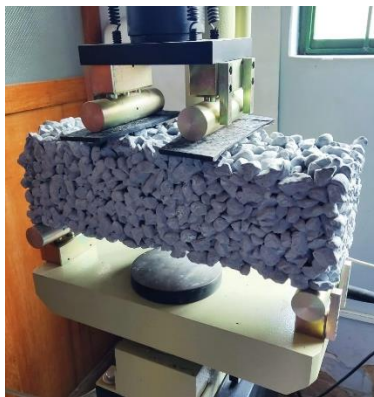
Ilustración 1. Montaje ensayo de resistencia a flexión. Fuente: Autor.
