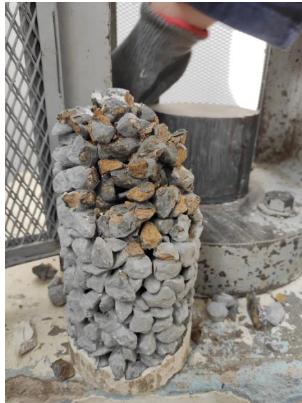
Ilustración 19. Espécimen con Agregado de cantera. Fuente: Autor.
