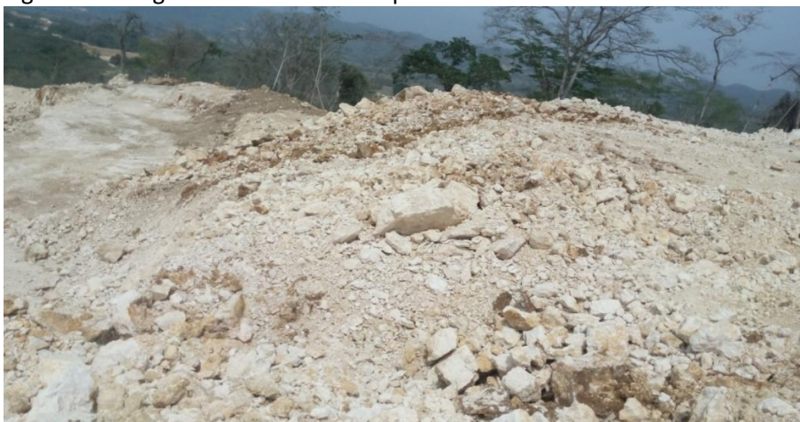
Figura 21. Fragmentación de la roca post voladura zona de sobretamaño
