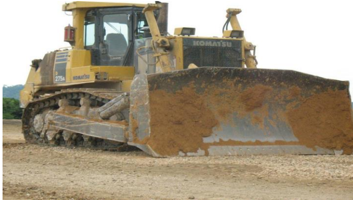
Figura 7. Equipos de arranque Bulldozer Komatsu 275
