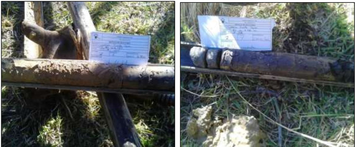
Fotografía 4 Muestra recuperada con dispositivo de cuchara partida.
