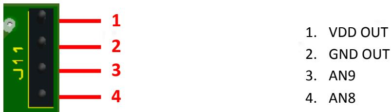
Figura 29. Entradas analógicas Acondicionadas dsPIC30F4013
