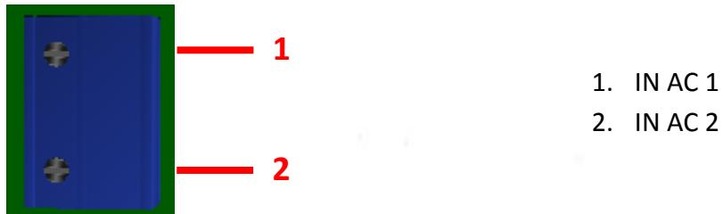
Figura 38. Conector entrada señales de control motores DC120V
