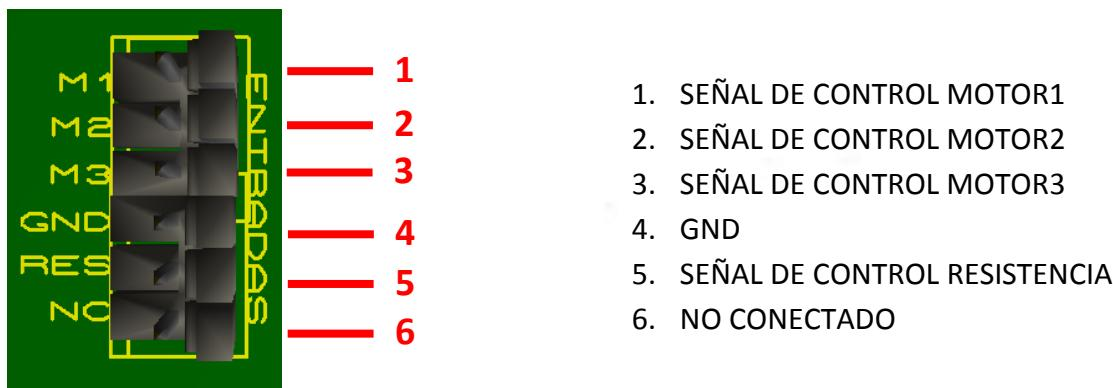
Figura 37. Conector entrada señales de control motores DC120V
