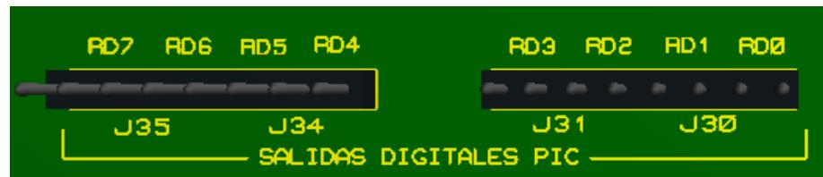
Figura 18. Conectores pines de salidas digitales PIC18F4550
