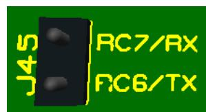
*Figura 24. Pines de comunicación USART ó Entrada/salida Digital Directa PIC18F4550*
