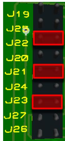
*Figura 3. Configuración comunicación SPI*
