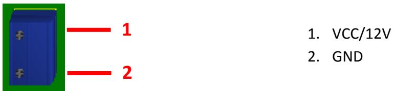
Figura 42. Borneras alimentación tarjeta control ON/OFF 110VAC
