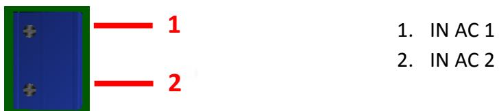
Figura 41. Borneras entrada señal 110VAC
