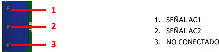
*Figura 26. Pines entradas analógicas PIC18F4550*
