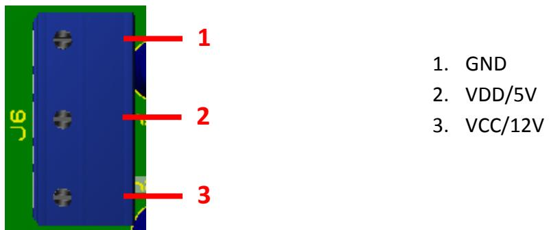
Figura 33. Bornera alimentación tarjeta drivers
