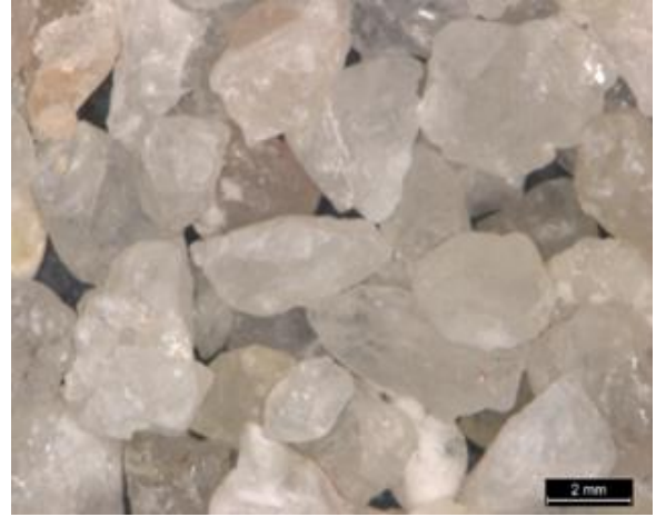
Figura 10. Microscopía óptica arena malla 20 a 40X. Fuente: (Autores, 2017).
