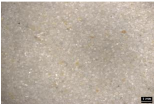
Figura 21. Microscopía óptica de arena 70 a 20X. Fuente: (Autores, 2017).
