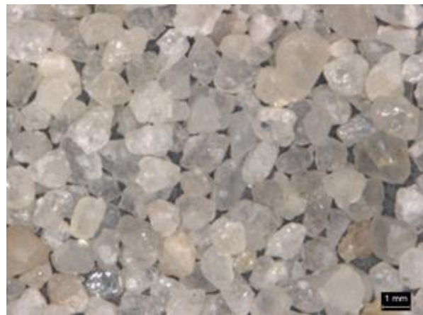
Figura 16. Microscopía óptica de arena malla 30 a 40X. Fuente: (Autores, 2017).
