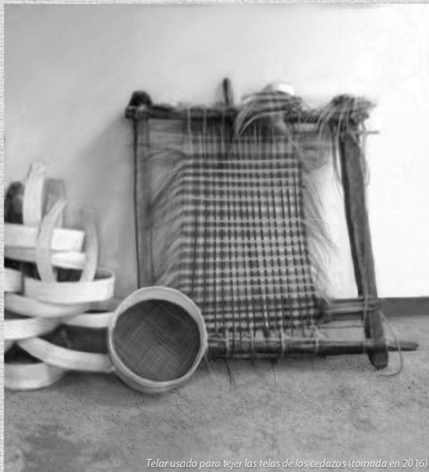
Telar usado para tejer las telas de los cedazos (tomada en 2016)
