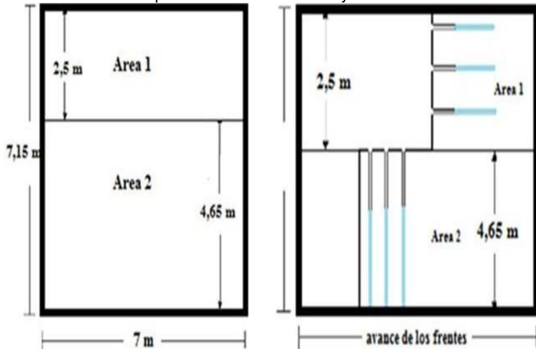
Figura 29: Frentes de explotación en vista Frontal y Perfil Mina El Toro.
