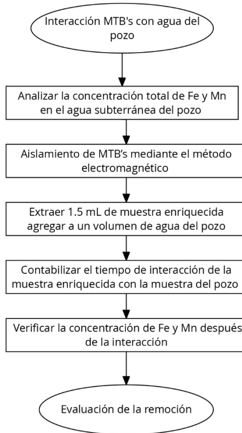
Figura 38. Diagrama de Procedimiento para la interacción de las muestras de agua subterránea con las MTB's.
