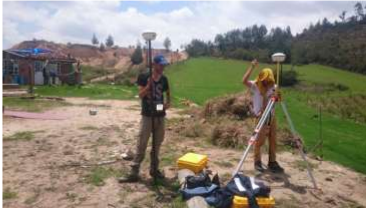
levantamiento de datos (G.P.S) Alta precisión
