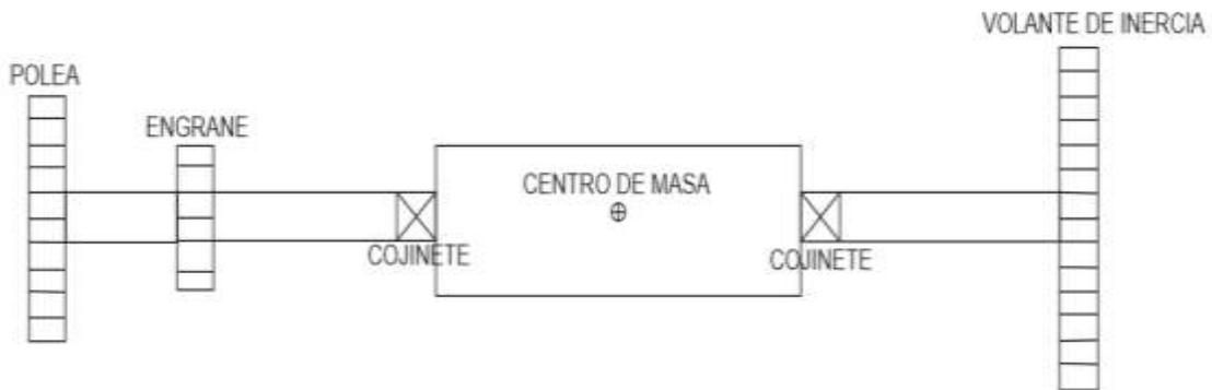
Figura 21. Diagrama de componentes mecánicas del eje con volante. Fuente: Autores
