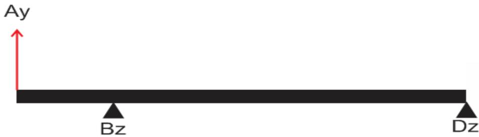
Figura 41. Diagrama del eje Z modelado como viga con dos apoyos eje sin volante. Fuente: Autores
