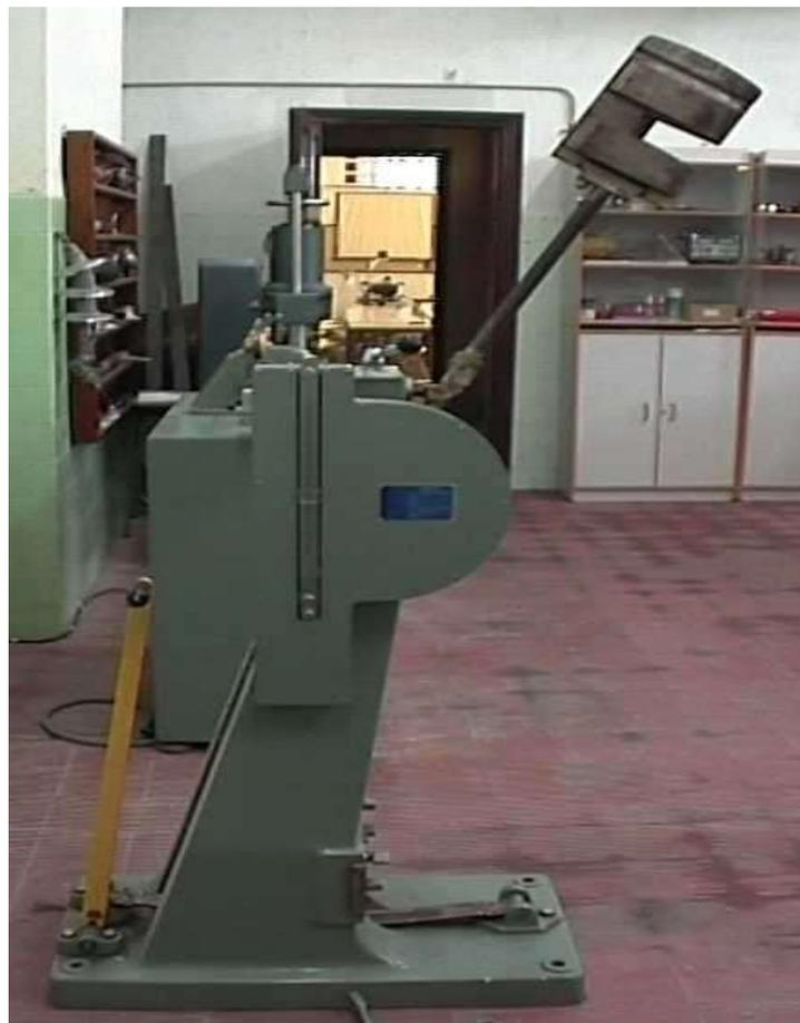
*Figura 8.* Máquina de ensayos universales Péndulo Charpy. Fuente Autores
