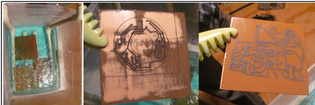
Figura. 5-7 Fabricación de las tarjetas de control
