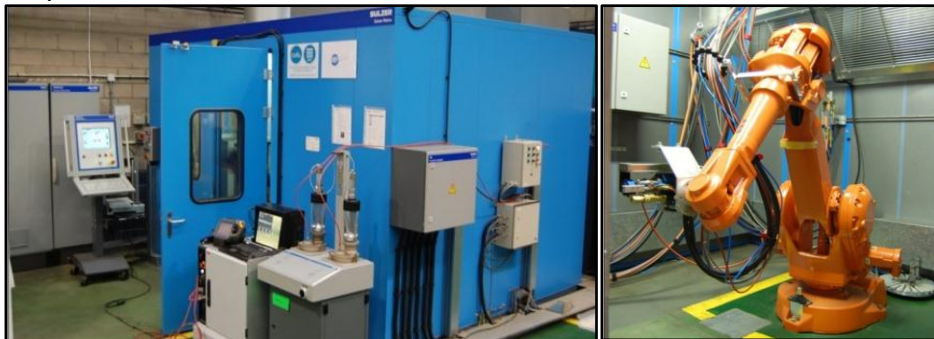
Figura. 1-9 Planta piloto para la obtención de recubrimientos, a la izquierda parte exterior a la derecha parte interior
