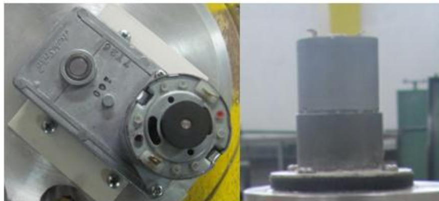
Figura. 3-7 Motores utilizados para movimiento del dosificador
