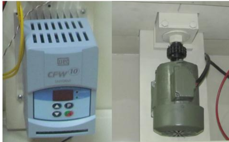
Figura. 3-6 Variador de velocidad y motor de corriente alterna
