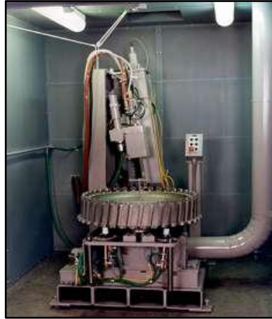
Figura. 1-31 Sistema de Spray con Plasma para recubrimientos de discos de ventilador
