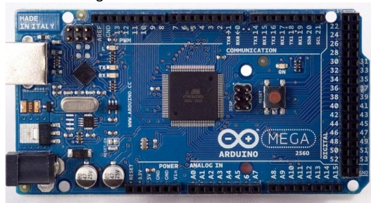
Figura. 3-3 Tarjeta Arduino Mega 2560 seleccionada
