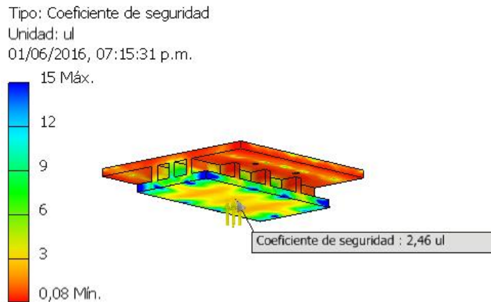
Figura 62. Coeficiente de seguridad de la mesa móvil. Software Autodesk Inventor Professional 2016®.
