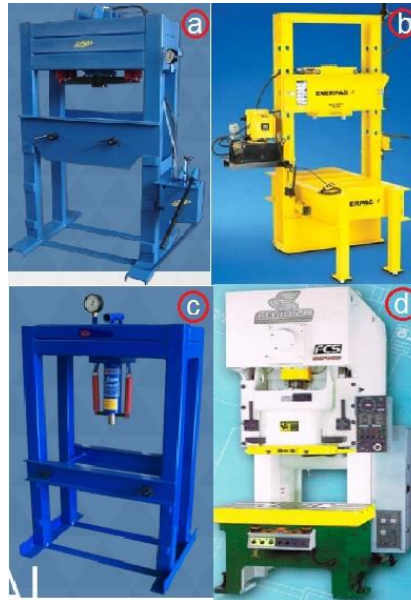
Figura 7. Ejemplos representativos de prensas. a) Prensa Hidráulica Reforzada manual tipo H-4 columnas. b) Prensa Hidráulica Automática tipo H-2 columnas. c) Prensa Hidráulica manual tipo H-4 columnas. d) Prensa Hidráulica Automática tipo C.
