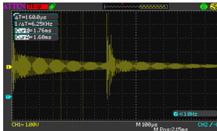
Figura 36. Onda de corriente en el primario cuando hay arco.
