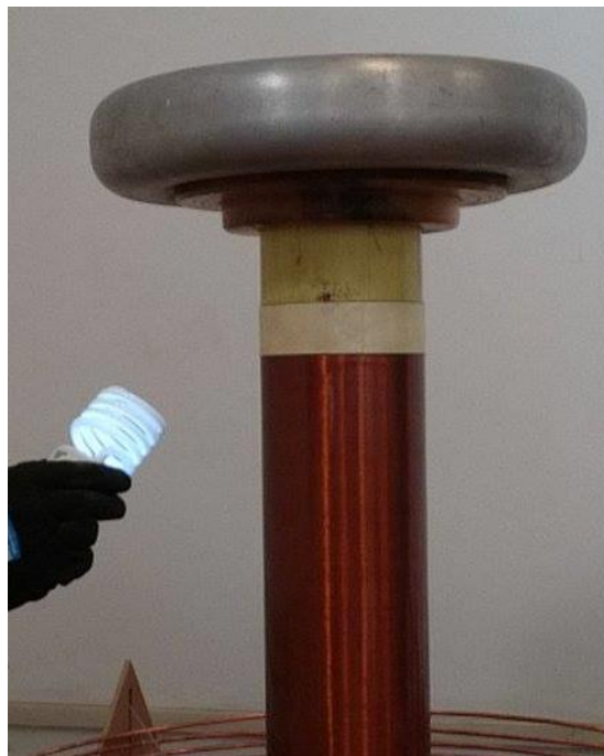
Figura 40. Encendido de lámparas con la bobina de tesla.
