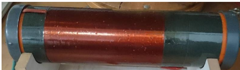
Figura 13. Bobina de choque
