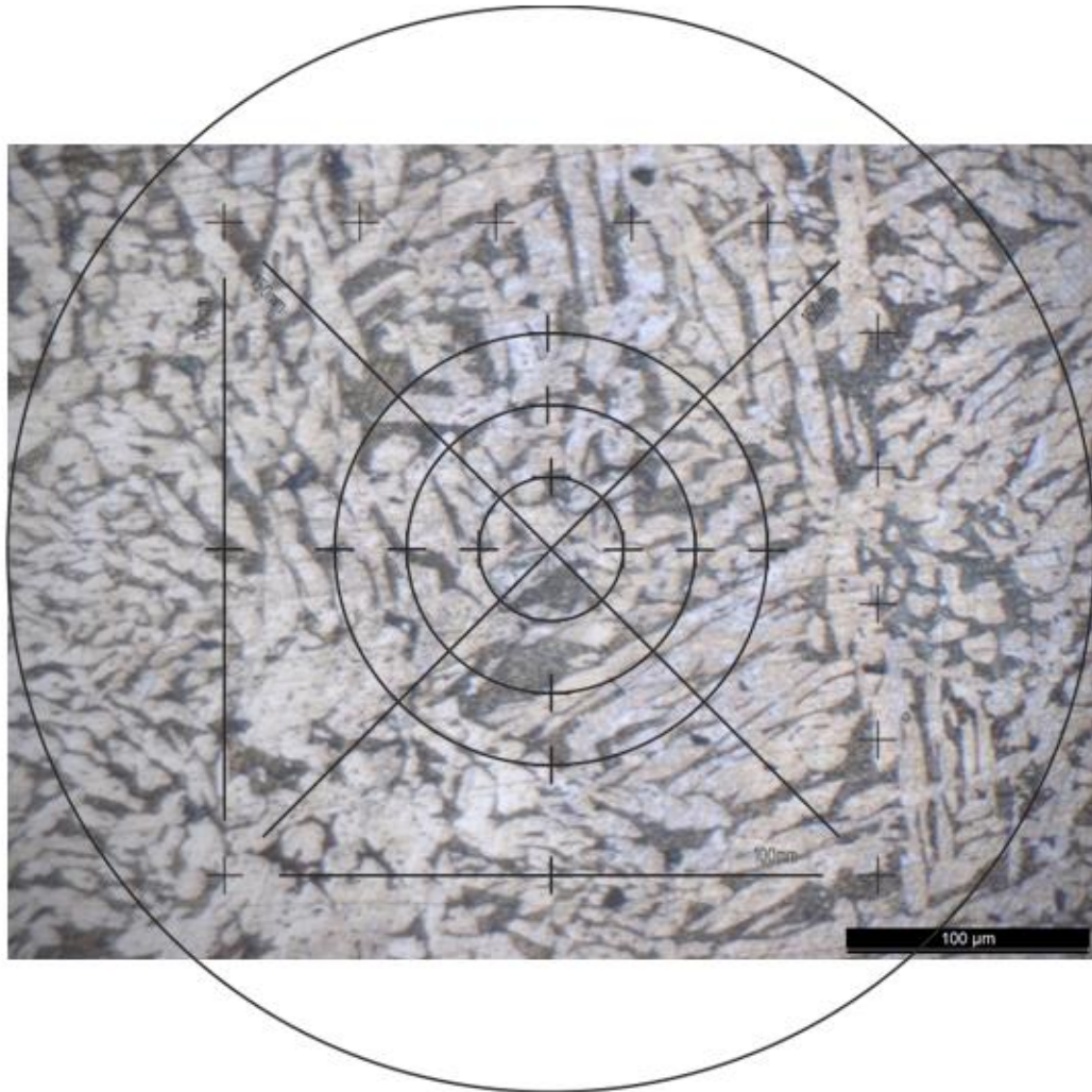
Figura 43. Micrografía longitudinal probeta 850°C y 3 pases por el tren de laminación 500X.
