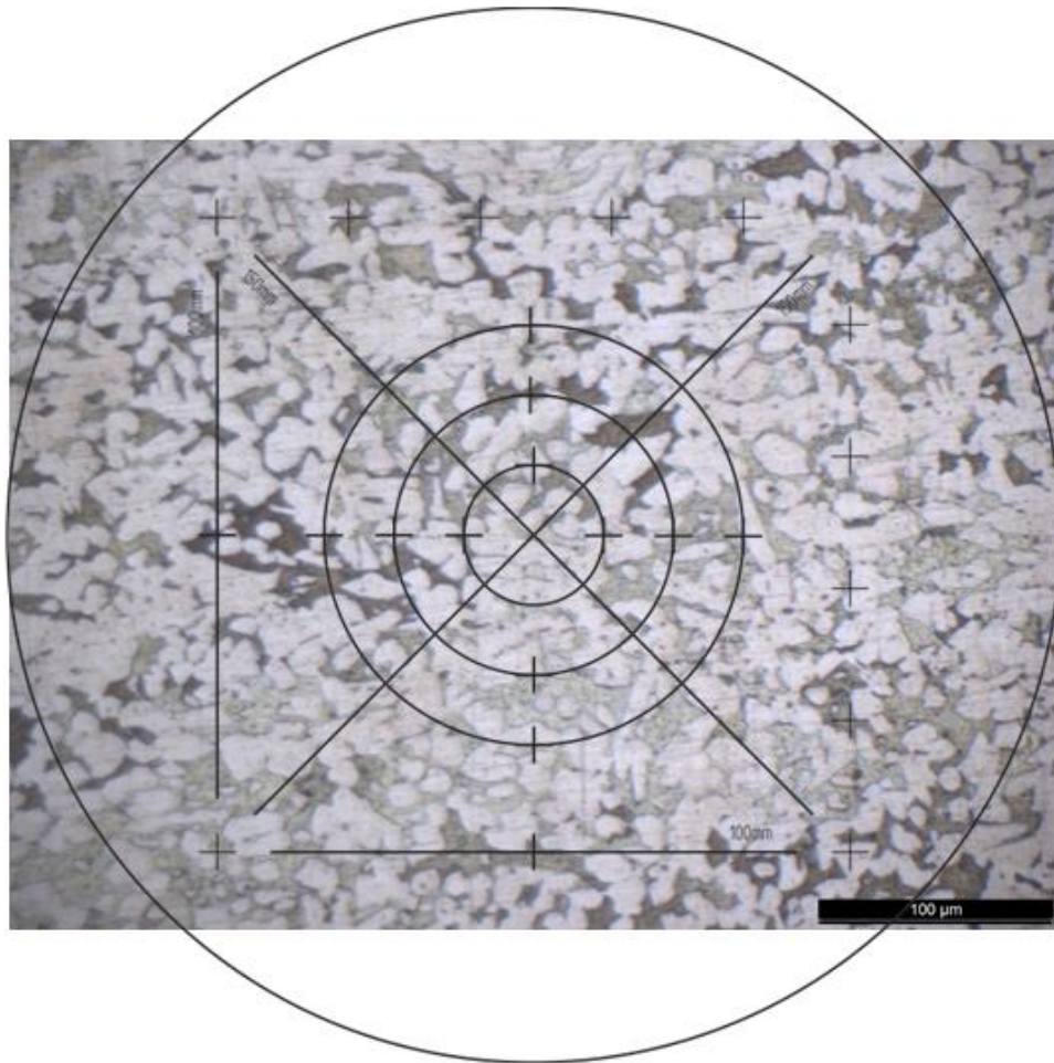
Figura 35. Micrografía longitudinal probeta base 500X.
