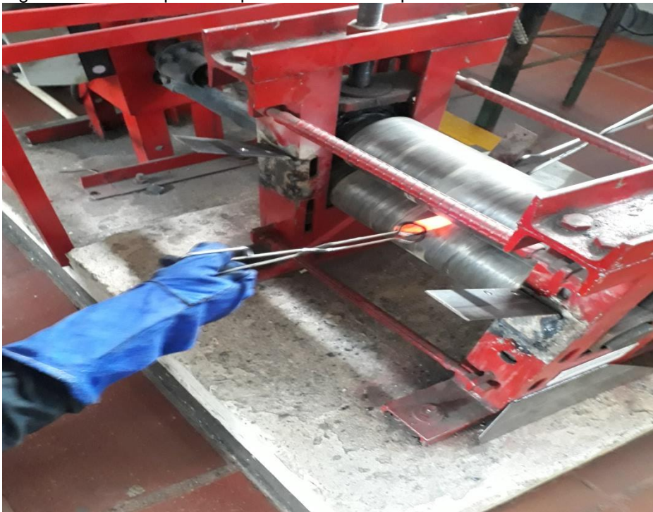
Figura 18. Probeta pasando por la laminadora tipo dúo.
