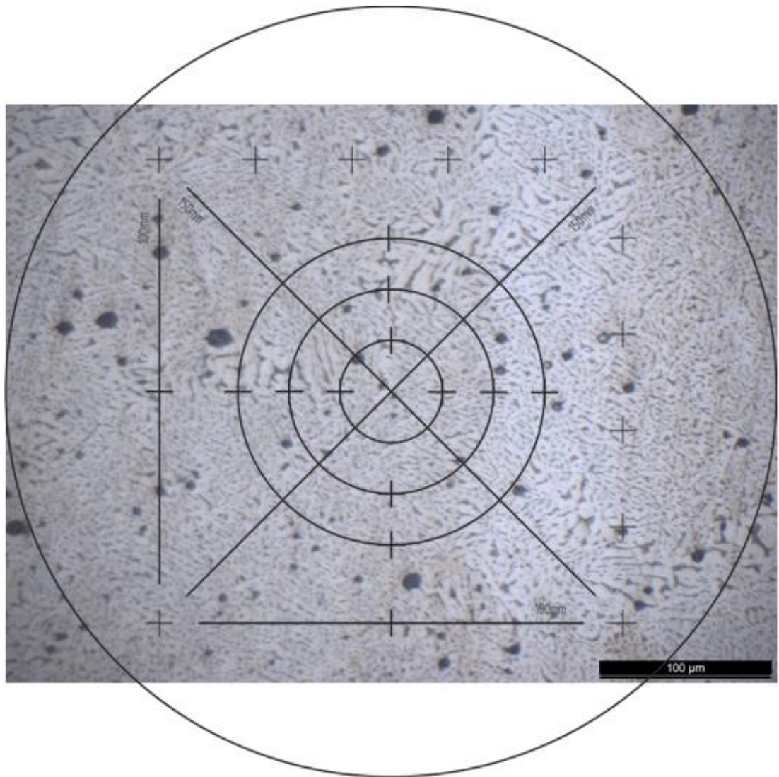
Figura 42. Micrografía longitudinal probeta 850°C y 2 pases por el tren de laminación 500X.
