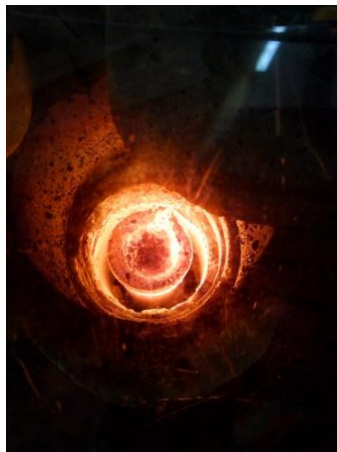
Figura 38. Refusión de botone en horno de inducción.
