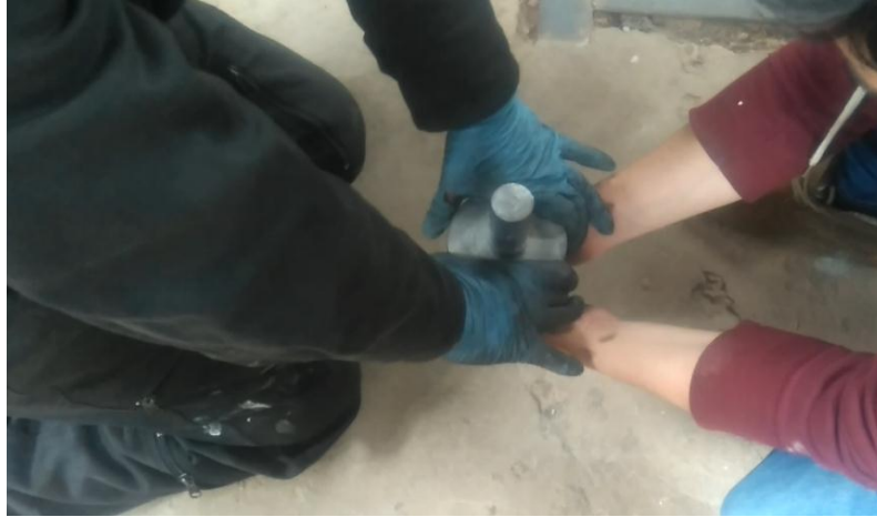
Figura 22. Desmontaje de las matrices de los crisoles.
