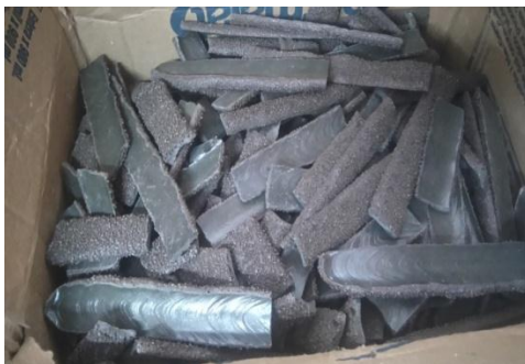
Figura 26. Escoria de arco sumergido, después del proceso de soldadura.
