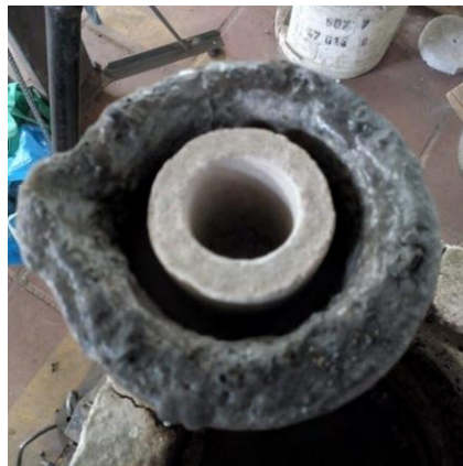
Figura 36. Cargue de crisol cerámico en crisol SiC
