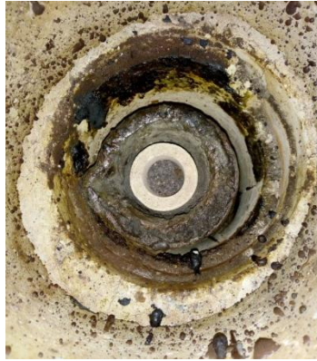
Figura 37. Crisoles cargados dentro de bobina de inducción
