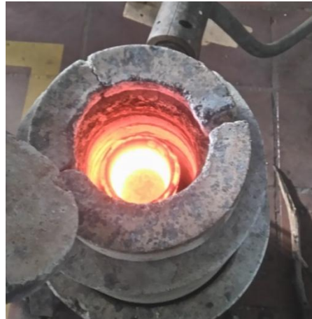
Figura 33. Fusión en bobina de Horno de Inducción.
