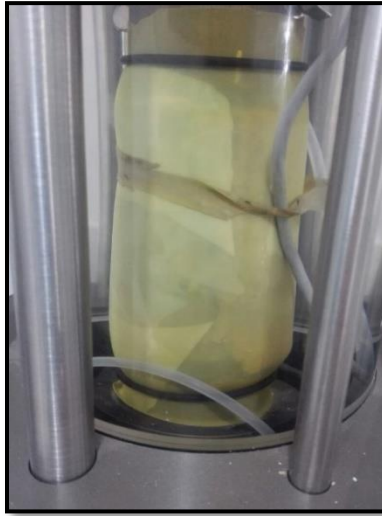
Figura 36. Muestra dañada durante el ensayo Bender Element
