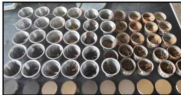
Figura 38. Ensayo de límites de Atterberg
