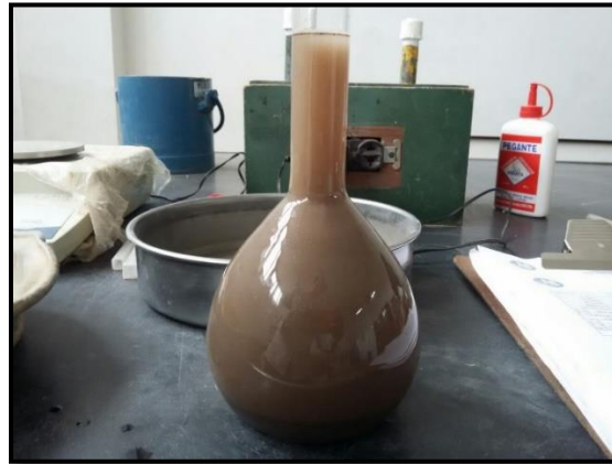
Figura 39. Ensayo de Gravedad Específica
