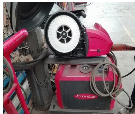
Fotografía 6: Equipo multiprocesos material de aporte GMAW
