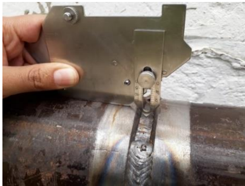
Fotografía 19: Evaluación falta de cordón de presentación en la probeta número 3
