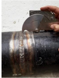
Fotografía 17: Evaluación de socavado en la probeta número 5
