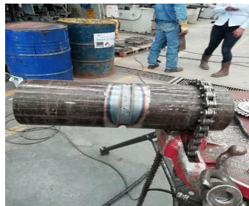
Fotografía 12: Aplicación pase de relleno
