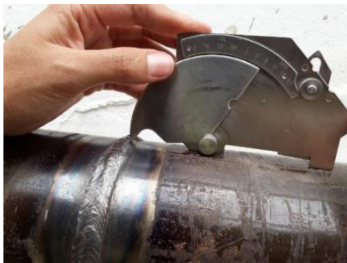
Fotografía 21: Evaluación de profundidad de porosidad en la probeta número 4
