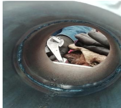
Fotografía 16: Verificación inducción de falla en el pase de raíz en probeta número 1
