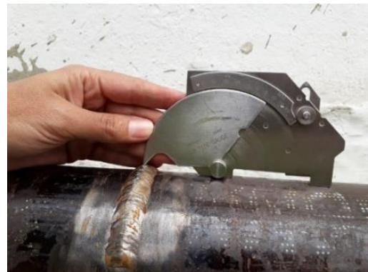
Fotografía 20: Exceso de sobre espesor (soldadura a tope) en la probeta número 3
