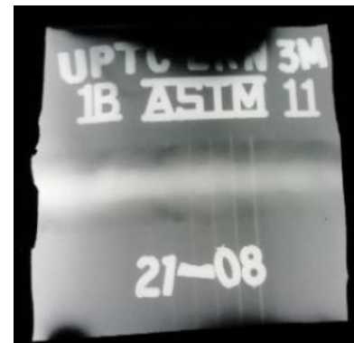
Fotografía 57: Radiografía probeta número 3
