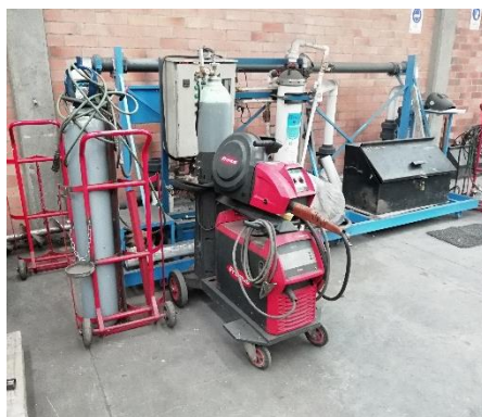
Fotografía 5: Equipo multiprocesos GMAW-GTAW
