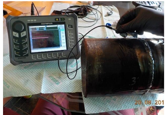
Fotografía 78: Puesta en práctica con equipo de ultrasonido convencional EPOCH 600
