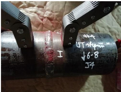
Fotografía 42: Probeta número 4 Con Yugo
