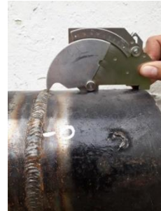
Fotografía 18: Evaluación de profundidad de porosidad en la probeta número 5
