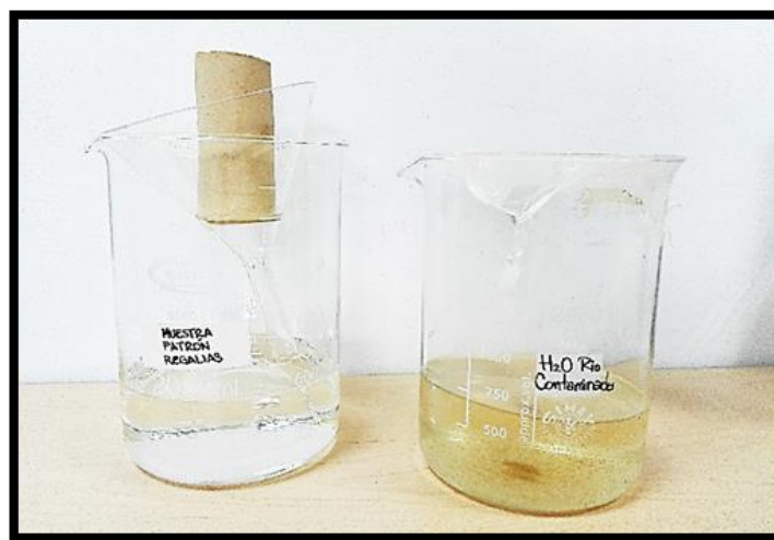
Figura 85. Filtración del filtro patrón.
