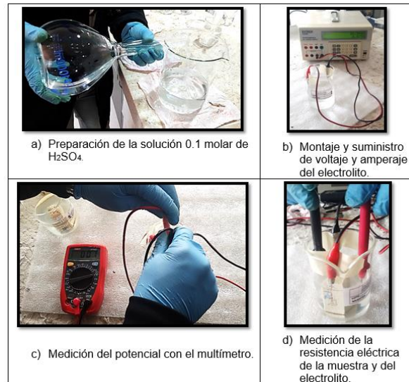
Figura 80. Montaje del ensayo electroquímico para la determinación del Factor de formación (F).
