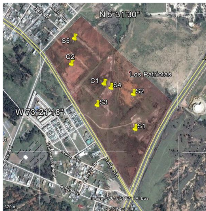
Figura 32 ubicación de los sondeos y calicatas, Zona de Estudio, barrio patriotas Tunja. Fuente. Google Earth.
