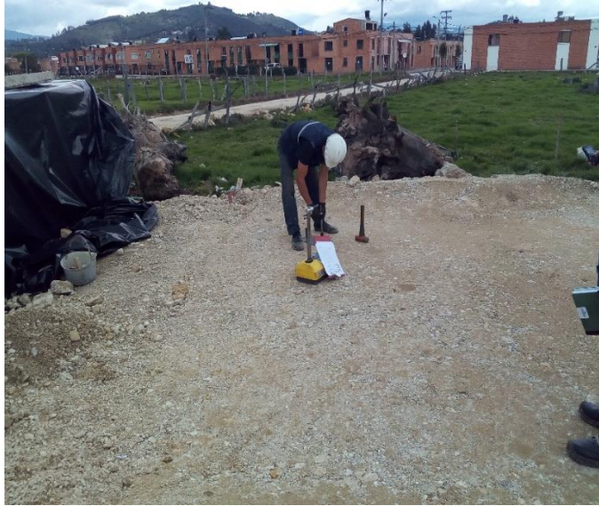
Ilustración 20. Toma de densidades con densímetro nuclear.
