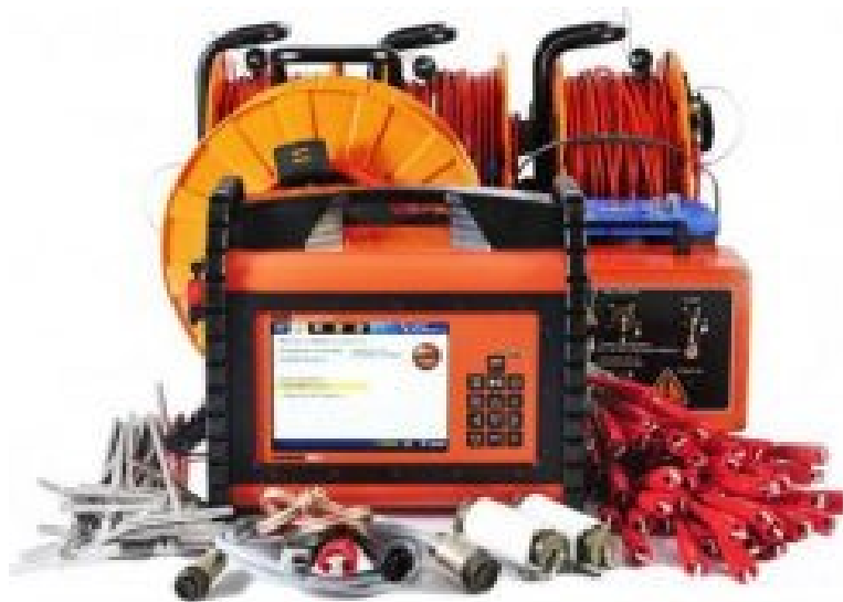
Figura 6. ABEM Terrameter LS. El dispositivo utilizado fue el Schlumberger, con variación de electrodos de potencial desde 0.5 hasta 200 metros. La distancia AB/2 , varió desde 1.5 hasta 300 metros. La figura 5, es una representación del arreglo de Schlumberger.
