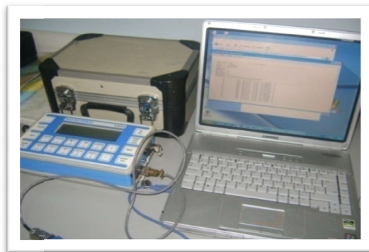
Figura17. Magnetómetro Scintrex y computadora con el programa para descarga de datos. Fuente. Elaboración propia
