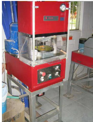
Figura 8. Prensa Hidráulica empleada. Fuente: Centro de Investigación de Materiales Cerámicos (CIMAC), Universidad Francisco de Paula Santander
