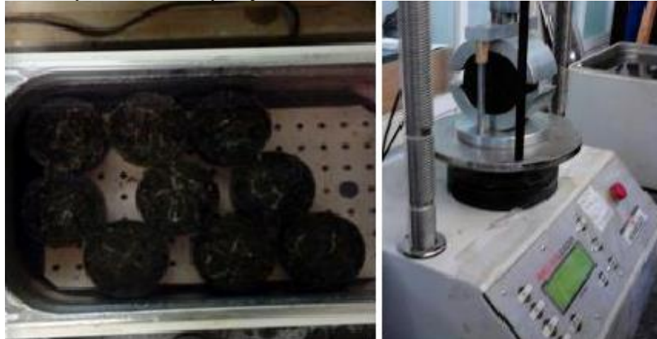
Figura 55. Ensayo Estabilidad y flujo Marshall.
