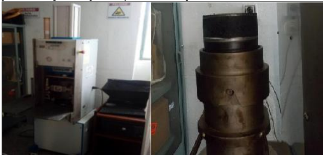
Figura 51. Compactador giratorio y molde de compactación.
