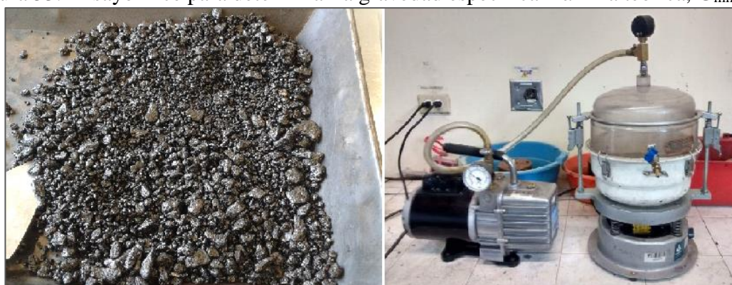
Figura 53. Ensayo Rice para determinar la gravedad específica máxima teórica, G_{mm}
