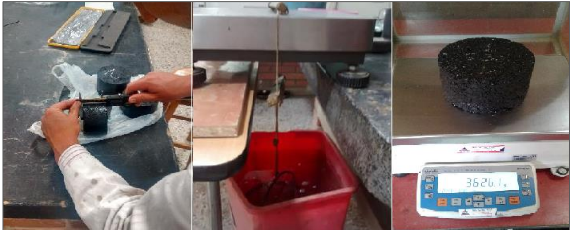
Figura 54. Ensayo gravedad específica bulk de probetas compactadas.
