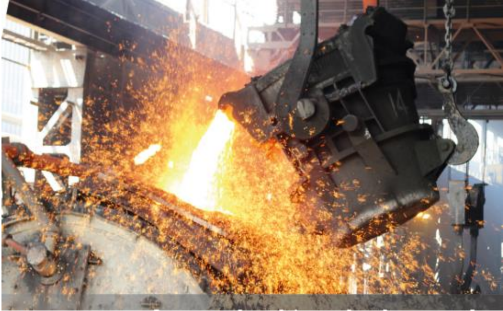
Figura 4. Descargue de arrabio en el convertidor
