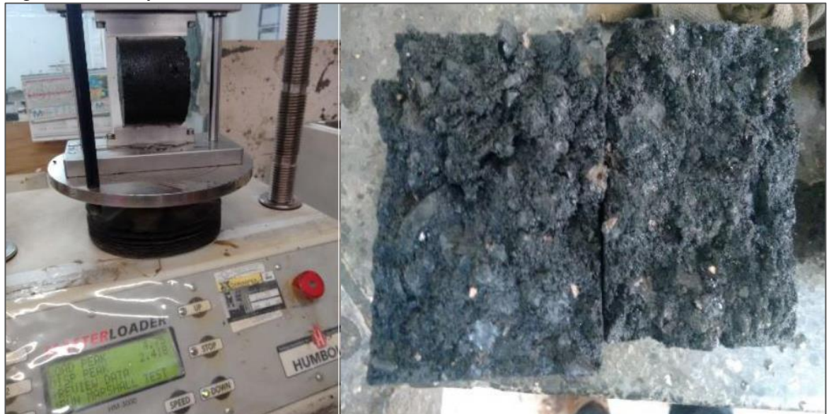
Figura 68. Ensayo de tracción indirecta.
