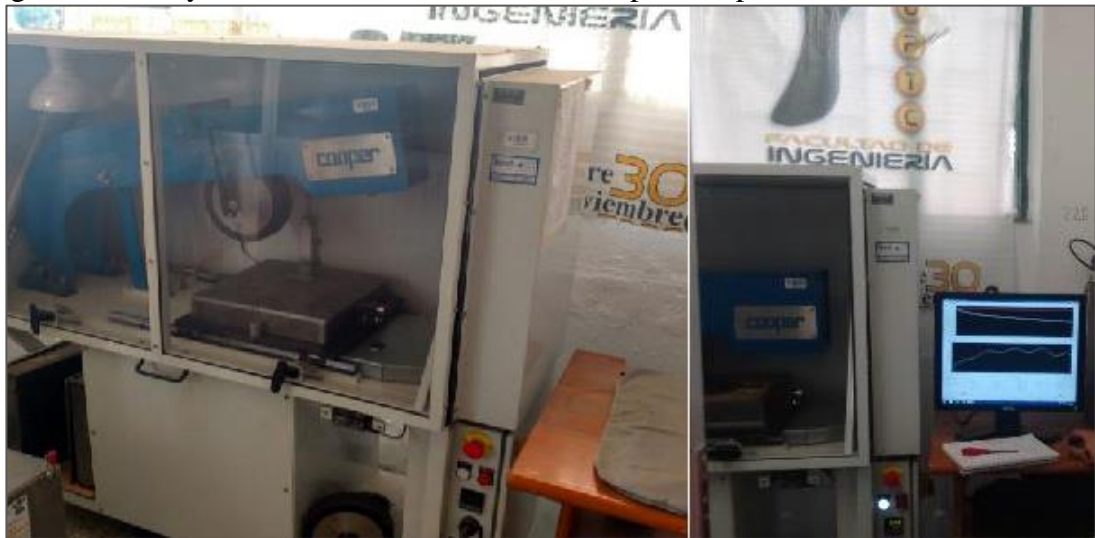
Figura 69. Ensayo de resistencia a la deformación plástica permanente.
