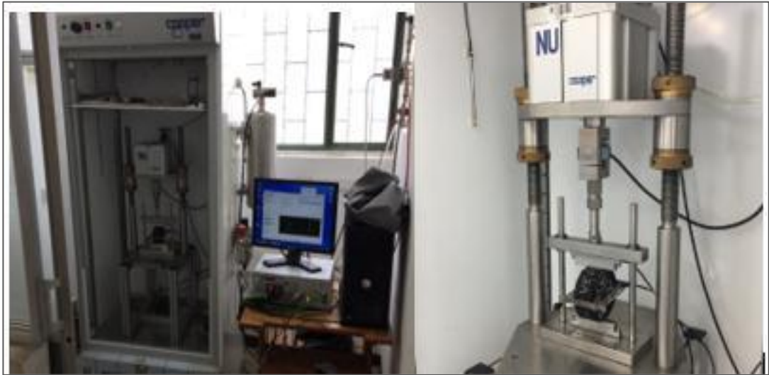
Figura 71. Equipo NAT para la determinación módulo resiliente
