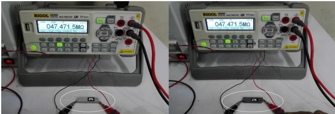
Fig. 52. Método de Kelvin para sistemas  $M_0$  (izquierda) y  $M_1$  (derecha)
