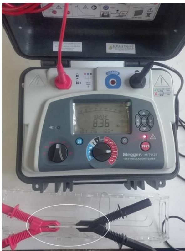
Fig. 54. Medición de resistencia sistema  $M_0$ .
