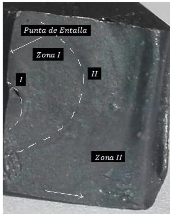
Fig. 62. Superficie de fractura a impacto del sistema  $M_5$ . Detalle: la flecha inferior indica el sentido de propagación de la grieta.
