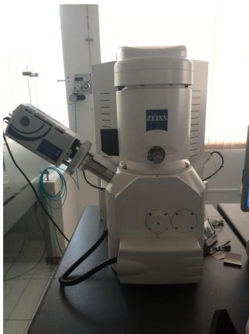
Fig. 34. MEB ZEISS Serie EVO | MA10.
