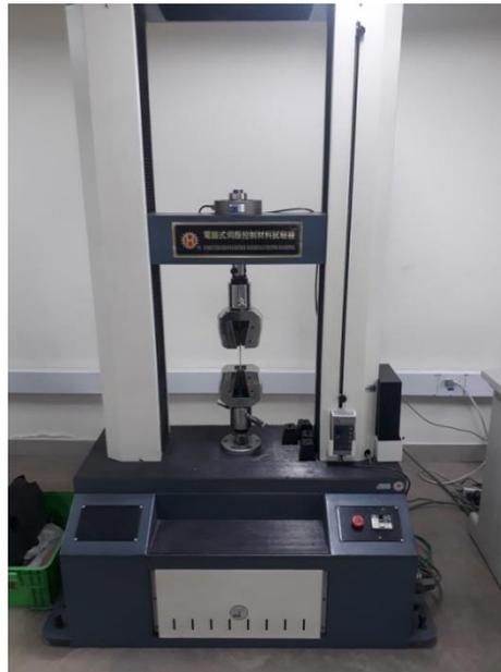
Fig. 41. Máquina universal tipo servomotor marca Hung Ta
