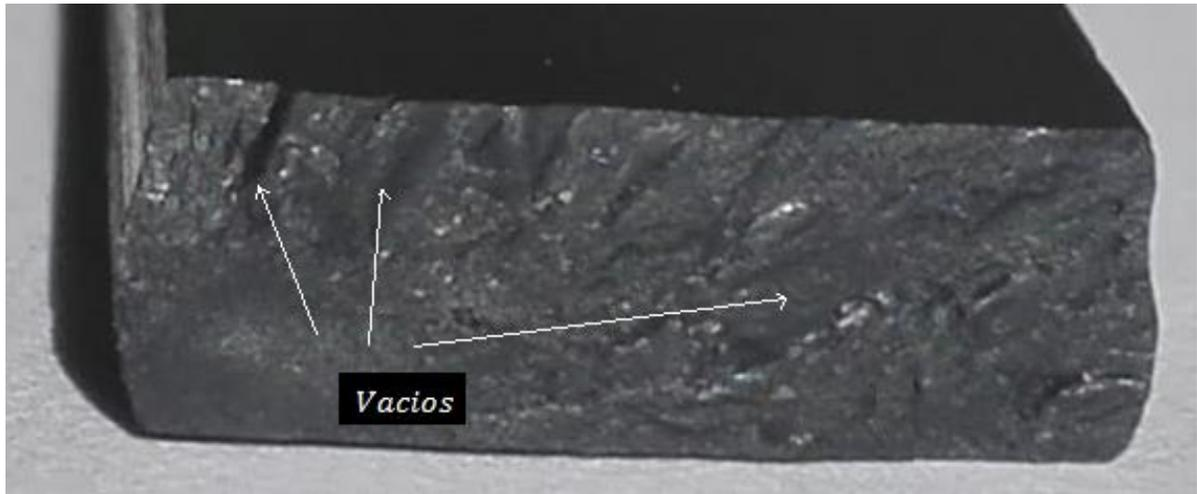
Fig. 58. Vista macroscópica del plano de la fractura a tensión del sistema M<sub>5</sub>
