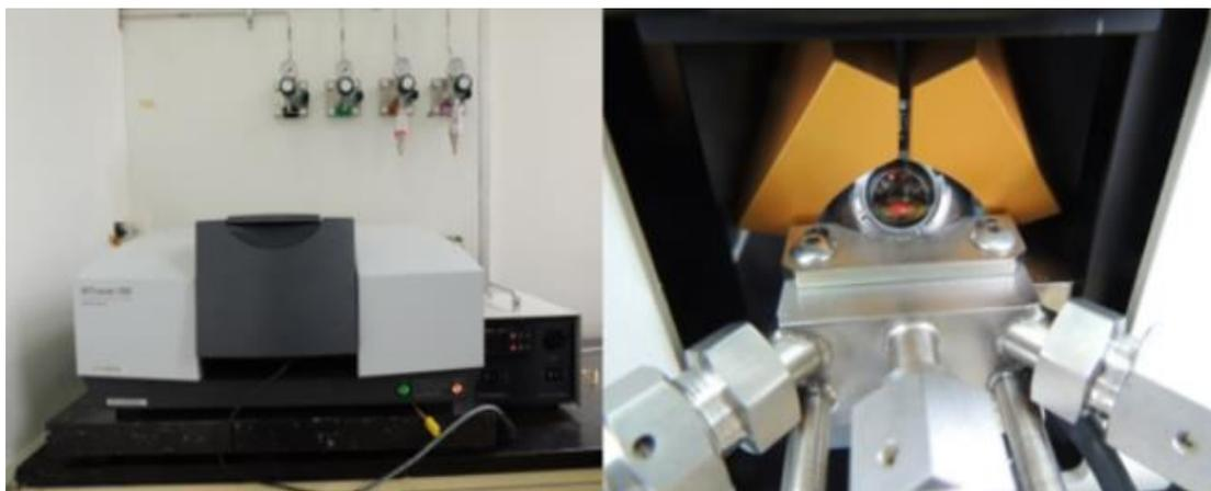
Fig. 36. Espectrómetro infrarrojo IR marca THERMO Fischer Scientific Nicolet iS10
