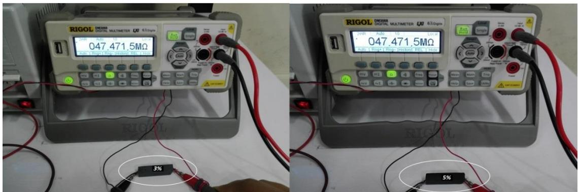
Fig. 53. Método de Kelvin para sistemas  $M_3$  (izquierda) y  $M_5$  (derecha)
