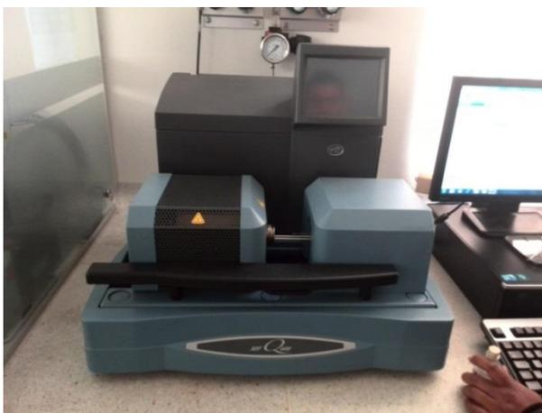
Fig. 35. Instrumento TA SDT-Q600 para TGA / DSC simultáneos.
