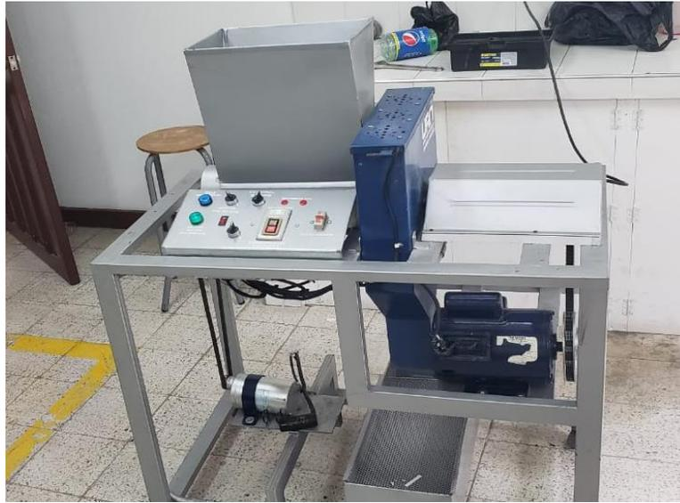
Fig. 15. Máquina pulverizadora de RPET.
