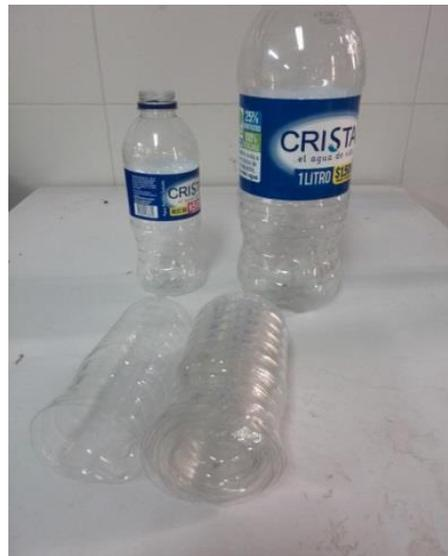
Fig. 16. Bobinas formadas de RPET.
