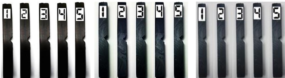
Fig. 32. Probetas de los sistemas M<sub>5</sub>, M<sub>3</sub> y M<sub>1</sub> para impacto (Norma ASTM D256-04).
