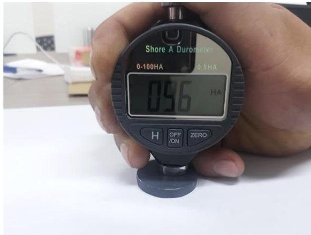
Fig. 59. Toma de dureza Shore A al sistema M<sub>3</sub>.
