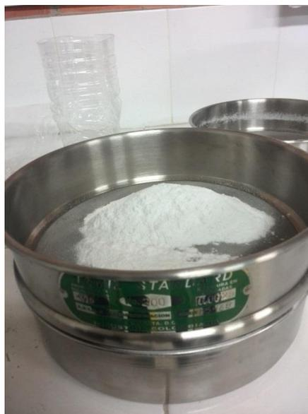
Fig. 18. RPET con tamaño de grano de 75  $\mu\text{m}$
