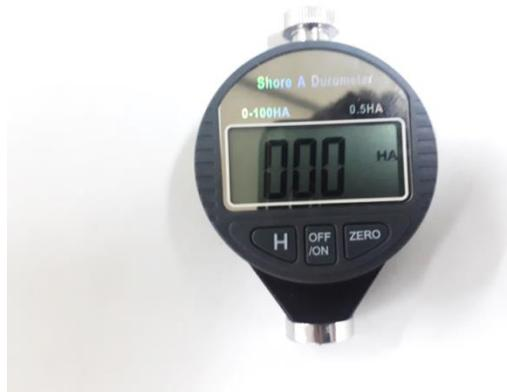
Fig. 42. Durómetro Shore A marca Onestopshops
