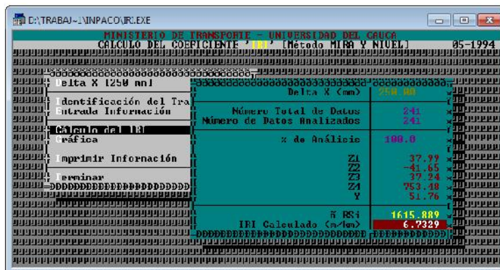
Figura 49. IRI Calculado para el Km 119 800-860 (IRI malo = 6.73 m/km) Fuente: SOFTWARE INPACO
