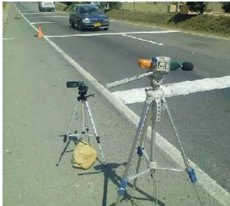
Figura 28. Posicionamiento de equipo de medición de volumen vehicular, cámara de video, abscisas Km 116 760-820.
