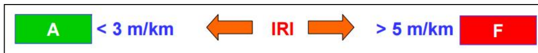
Figura 9. Clasificación de un tramo según su condición funcional – Regularidad de la superficie
