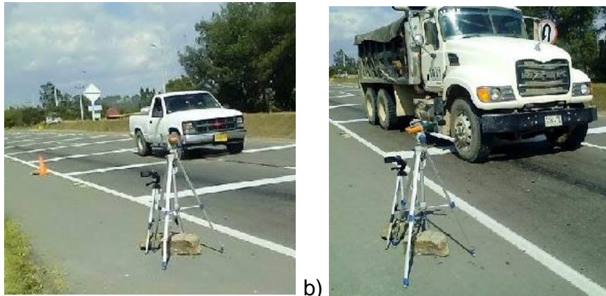
Figura 37. Medición del ruido con el sonómetro y toma de video abscisas Km 122 100-160. a) al paso de vehículo. b) al paso de camión
