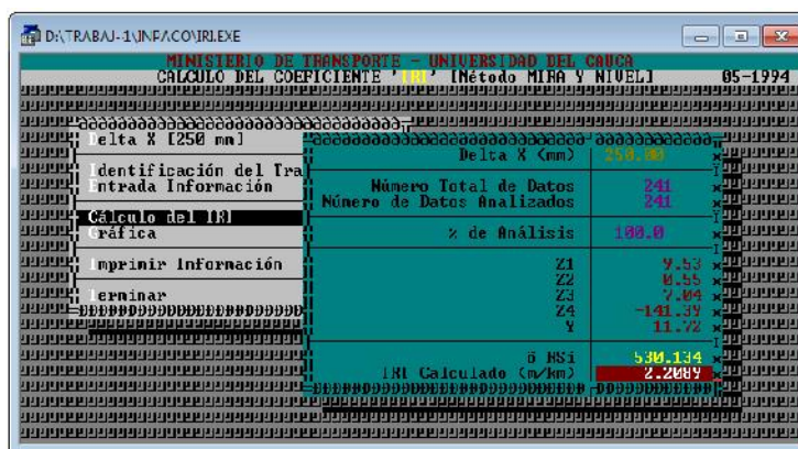
Figura 50. IRI Calculado para el Km 122 100-160 (IRI bueno = 2.21 m/km) Fuente: SOFTWARE INPACO
