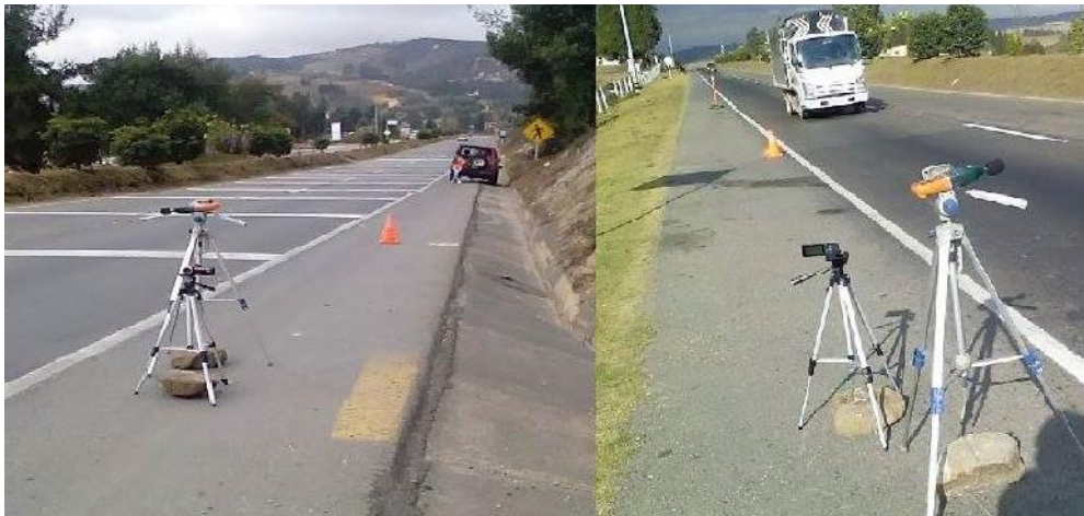
Figura 22. Cámara filmadora para registrar velocidades de los vehículos.
