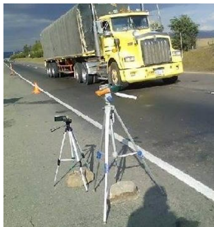
Figura 36. Medición del ruido con el sonómetro y toma de video abscisas Km 119 800-860. Fuente: Propia.
