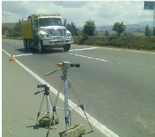
Figura 26. Posicionamiento de equipo de medición del ruido con el sonómetro y toma de video, abscisas Km 116 460-520, de un camión. FUENTE: Propia.
