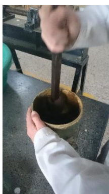
Figura 51:Proceso de engrase de los moldes.
