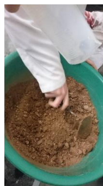
Figura 52:Procedo de mezcla del material con la humedad requerida.
