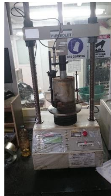
Figura 56: Montaje de falla del molde.
