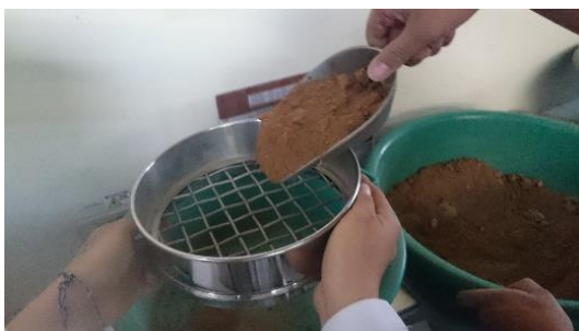
Figura 42:Procedimiento de tamizado del Material, Tamiz 3/4".
