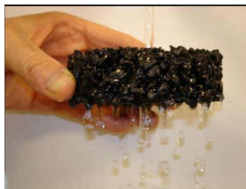
Figura 6: Mezcla asfáltica drenante. (Flexible Pavements of Ohio, n.d.).
