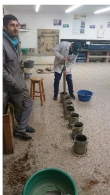
Figura 53:Proceso de compactación: 5 capas.
