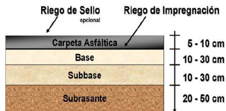
Figura 4: Estructura típica de un pavimento flexible: zonas de riego y espesores recomendados.
