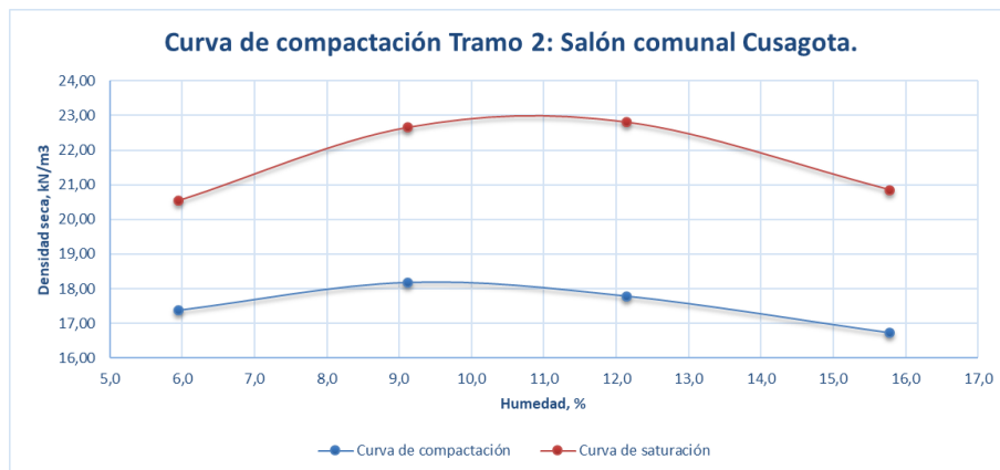
Figura 47: Curva de Compactación tramo 2: Salón comunal Cusagota.
