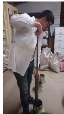
Figura 45:Proceso de compactación: 5 capas, 56 golpes por capa.
