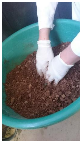
Figura 44:Procedo de mezcla del material con la humedad requerida.
