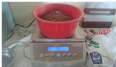
Figura 50: Separación del material, peso 5 Kg.
