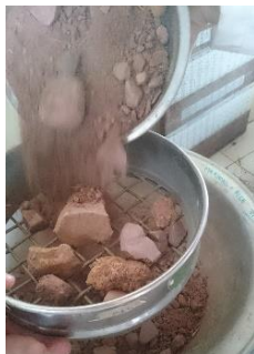
Figura 49:Procedimiento de tamizado del material: Tamiz 3/4".
