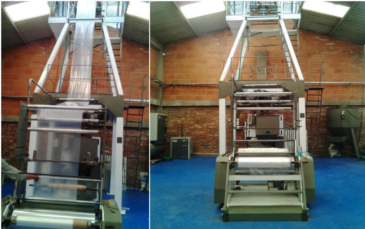
Figura 8. Maquina extrusora; de doble tornillo bicapa ancho máximo 80cm y mínimo 30cm.
