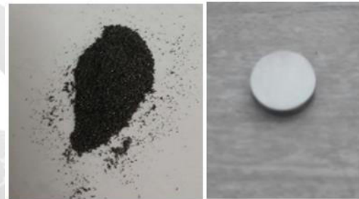
Fig. 2. Izq. Muestra en polvo. Der. Muestra sólida de aleación Ti-6Al-4V. Fuente: Autores del proyecto
