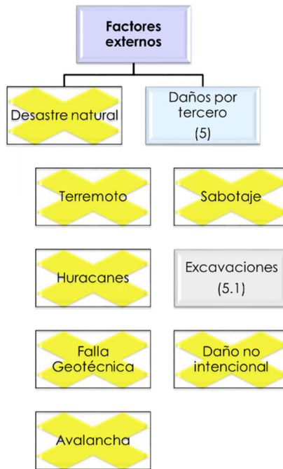
Ilustración 15 Árbol Lógico de fallas por factores externos basado en ASME B31.8S [3]
