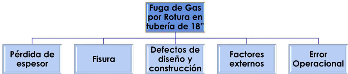
Ilustración 6 Árbol Lógico de fallas basado en ASME B31.8S [3]
