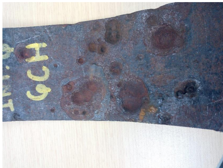
Ilustración 6. Daño en sección por bacterias en tubería de 16 in
