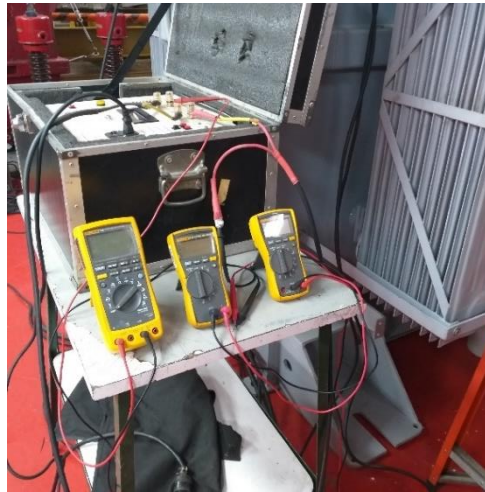
Figura 35 Equipos utilizados para medir la resistencia en caliente
