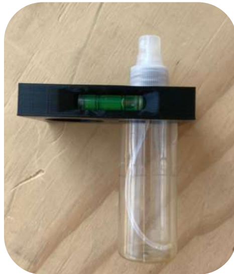
Figura 64 Contenedor y nivel ajustados a fracción de la base
