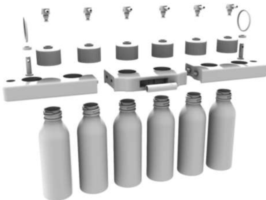
Figura 85 Visualización despiece 3D Instrumento de medición
