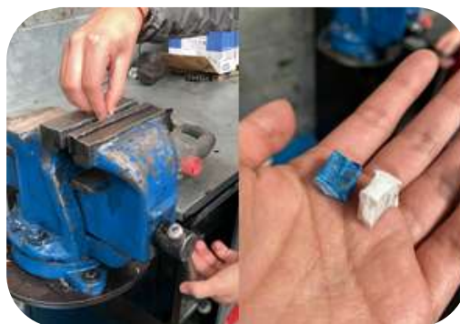
Figura 58 Prueba de resistencia a prensa
