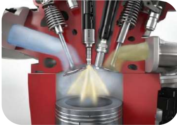
Figura 12 Cámara de admisión de combustible para combustión
