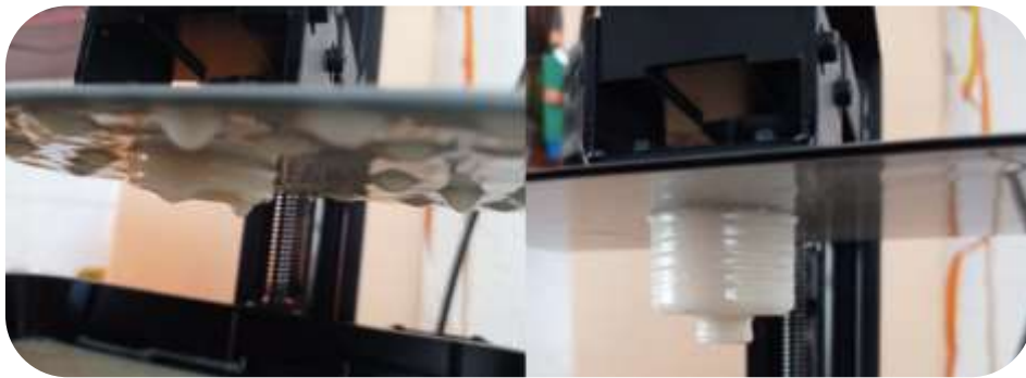
Figura 102 Proceso de impresión de las tapas en resina foto curable
