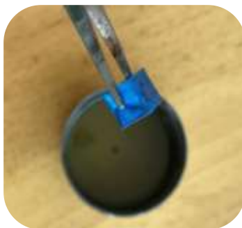
Figura 56 Cubo de PLA finalizada la prueba sin afectaciones
