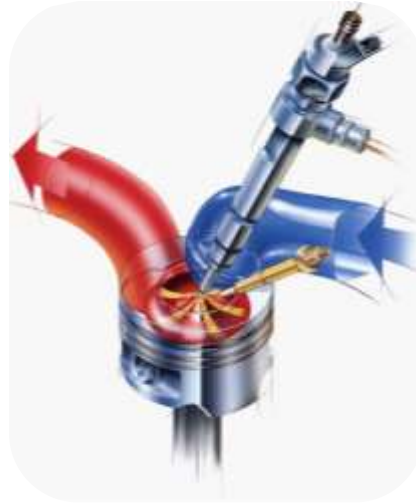
Figura 10 Sistema de inyección directa
