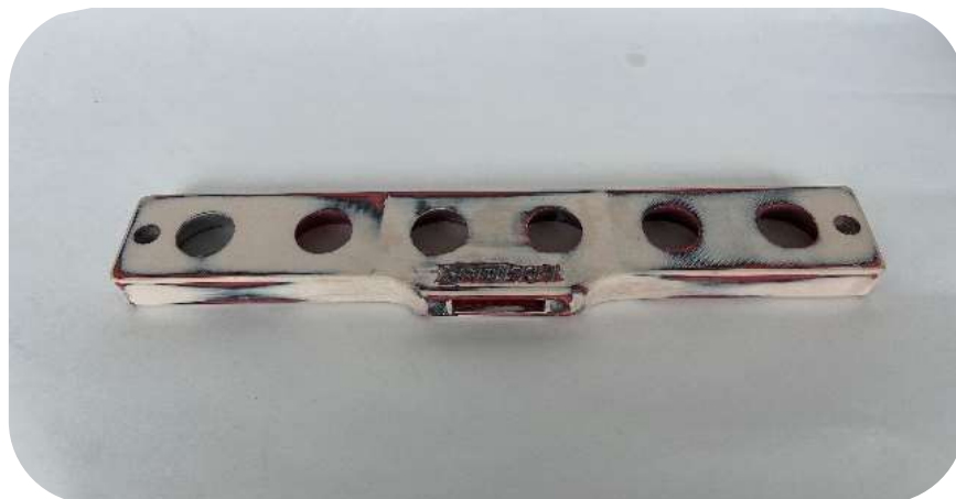
Figura 126 Base estructural lijada
