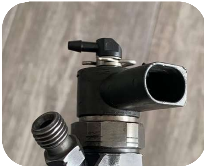
Figura 70 Pin de seguridad, racor e inyector
