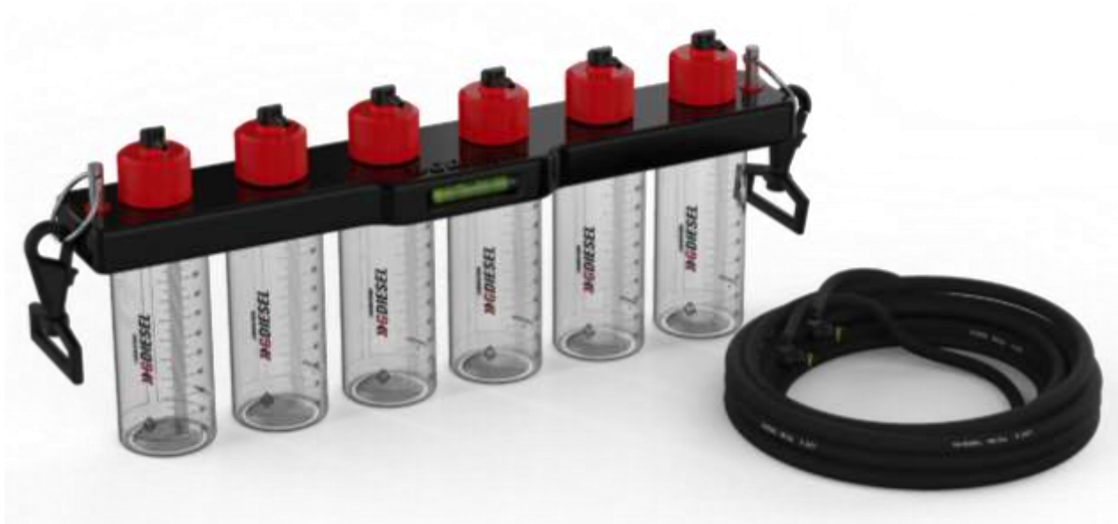
Figura 93 Visualización 3d del instrumento de medición con mosquetones y mangueras
