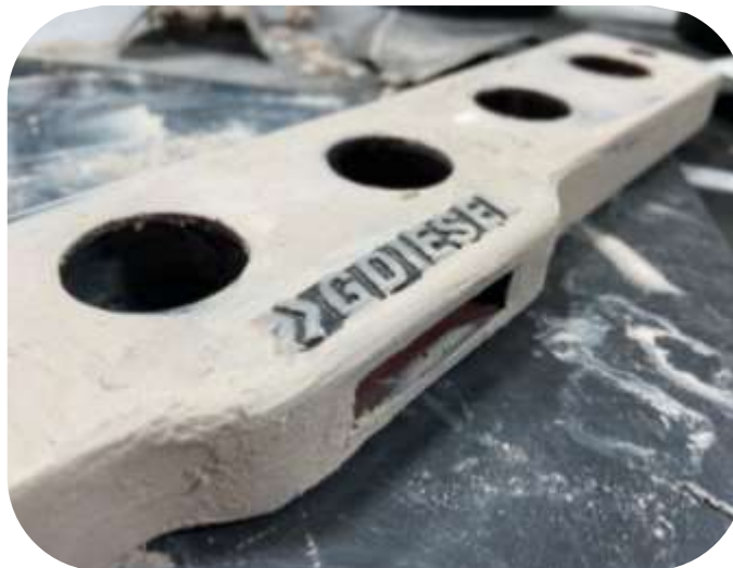
Figura 124 Vista a detalle de la aplicación de masilla epóxica en la base estructural
