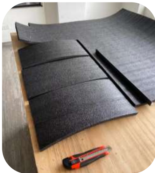
Figura 141 Corte de capas de espuma Yumbolon.
