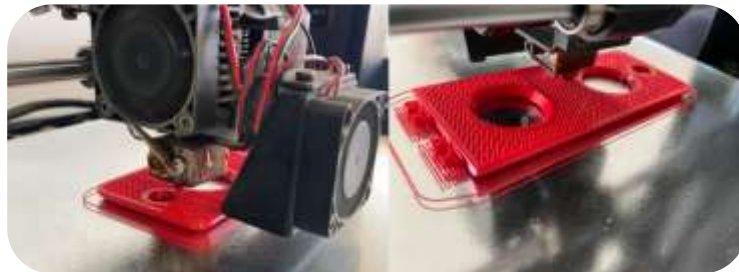
Figura 114 Proceso de impresión 3d piezas de base estructural
