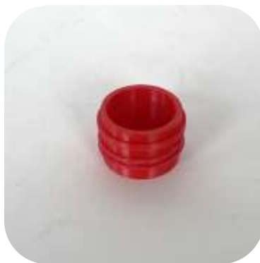
Figura 50 Impresión 3D del cuello y rosca del recipiente contenedor
