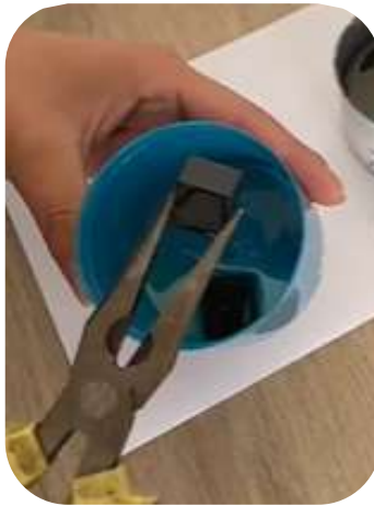
Figura 59 Cubo de PLA luego de prueba en gasolina
