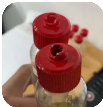
Figura 108 Fractura que se puede presentar en la tapa debido a su uso continuo
