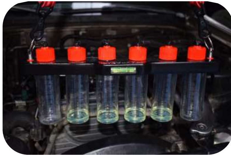
Figura 156 Combustible retornado durante la prueba de inyección
