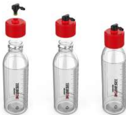
Figura 88 Visualización 3d, apariencia final del Racor, Tapa y recipiente contenedor del instrumento
