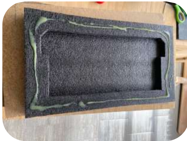
Figura 145 Aplicación de pegamento a las capas de espuma para su unión
