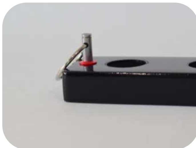
Figura 132 Apariencia final de la base, vista a detalle de perno y argolla
