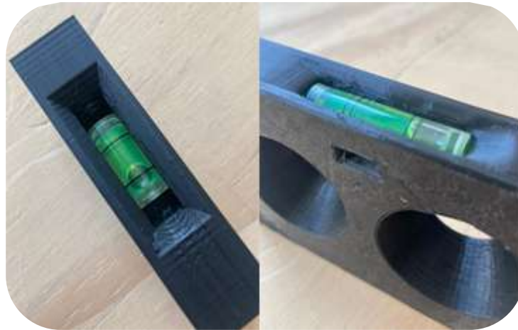
Figura 63 Alternativas de encaje para nivel
