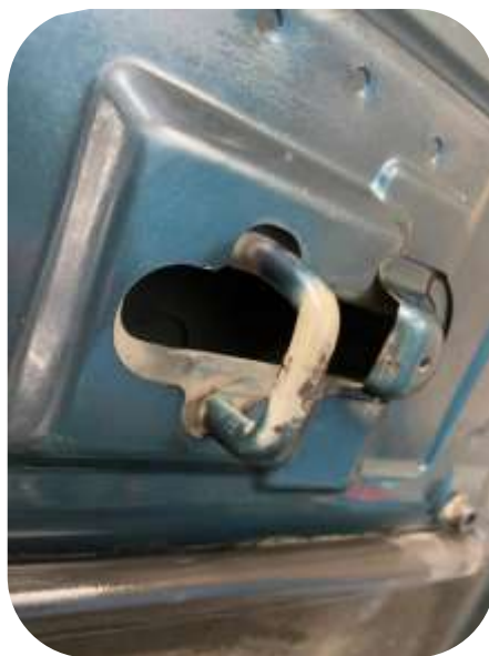
Figura 81 Vista a detalle del gancho del capó
