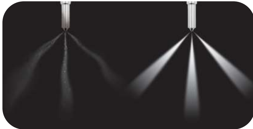
Figura 13 Comparación inyector averiado e inyector limpio
