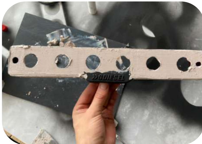
Figura 123 Aplicación de masilla epóxica en la base estructural
