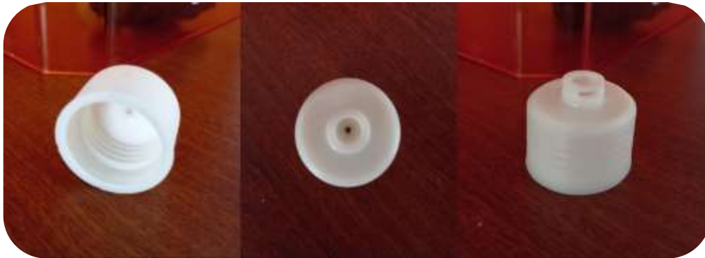
Figura 103 Tapa impresa en resina foto curable.
