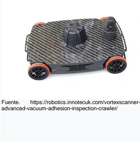
Ilustración 4. VortexScanner, Crawler de inspección
