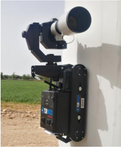
Ilustración 6. Robot inspector de palas
