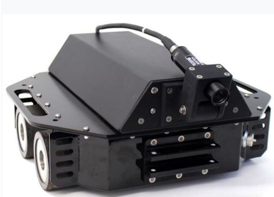
Ilustración 2. Hunter Crawler de inspección
