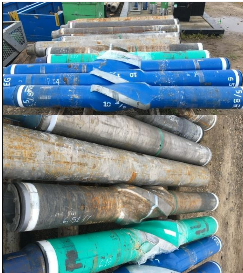
Ilustración 4.- Near Bit Stabilizer & String Stabilizer de 10 3/8" y 10 1/2".
