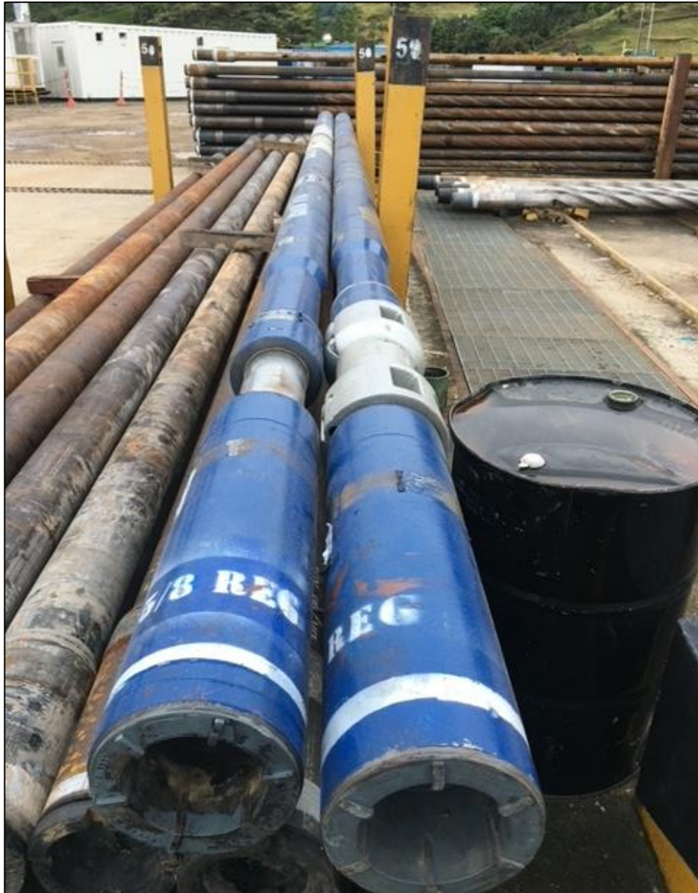
Ilustración 7.- Conjunto martillo y acelerador hidráulicos de 8 ¼”
