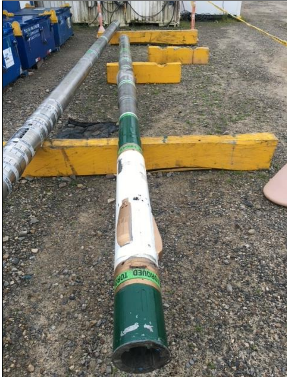
Ilustración 2.- Sistema Rotativo Direccional – RSS de 6 3/4" x 10 5/8"
