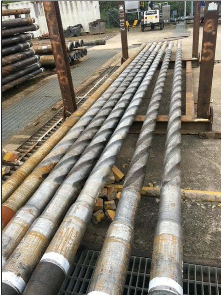
Ilustración 5. -Tubería Pesada de Perforación de 5 7/8" 49.17 lb-ft.
