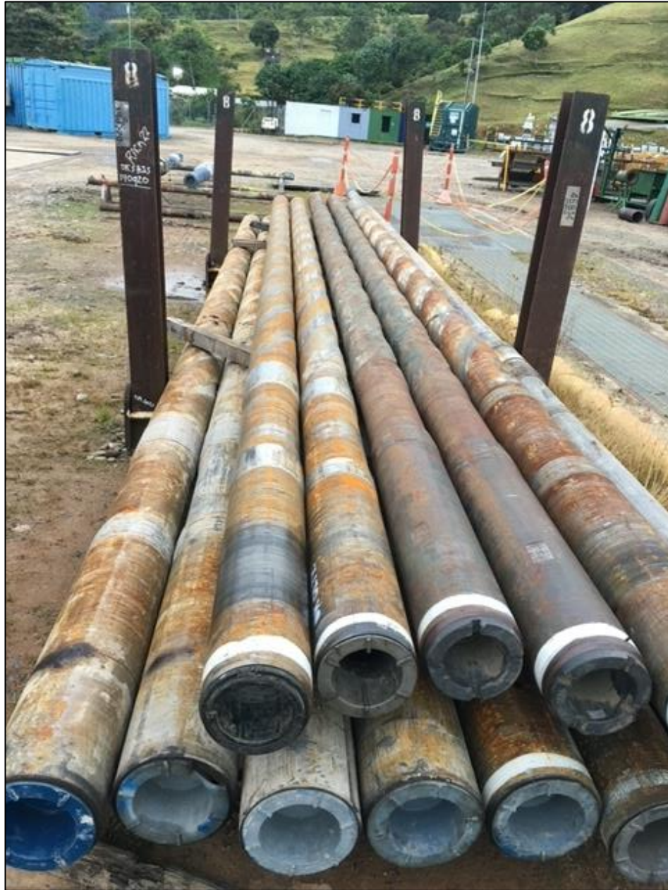
Ilustración 6.- Drill Collars o botellas de perforación.
