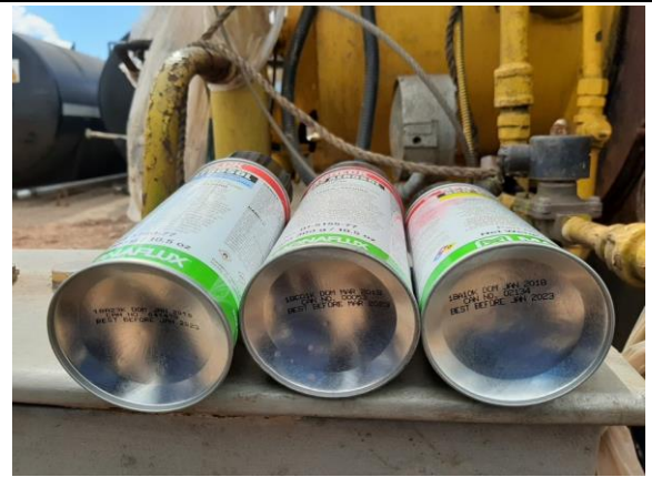
Kit de Líquidos penetrantes usados durante la inspección PT
