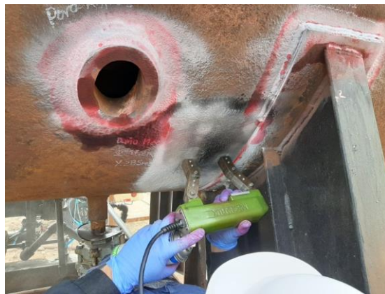
Resultado de MT negras con pintura de contraste en abolladura
