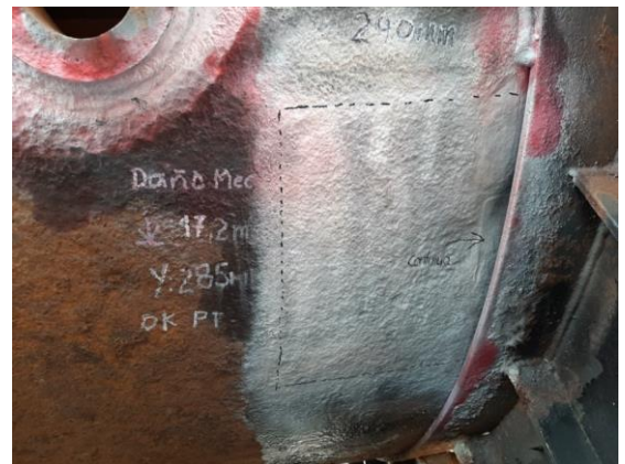
Resultado de MT negras con pintura de contraste en abolladura del cuerpo de la caldera
