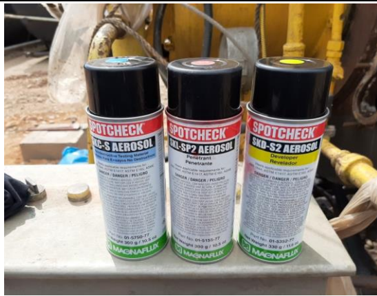
Kit de Líquidos penetrantes usados durante la inspección PT
