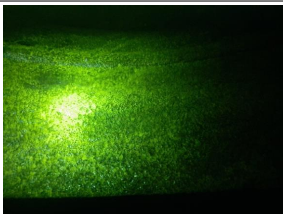
Resultado de MT fluorescentes en sector del extremo del Tubo Hogar zona de las 6:00hr
