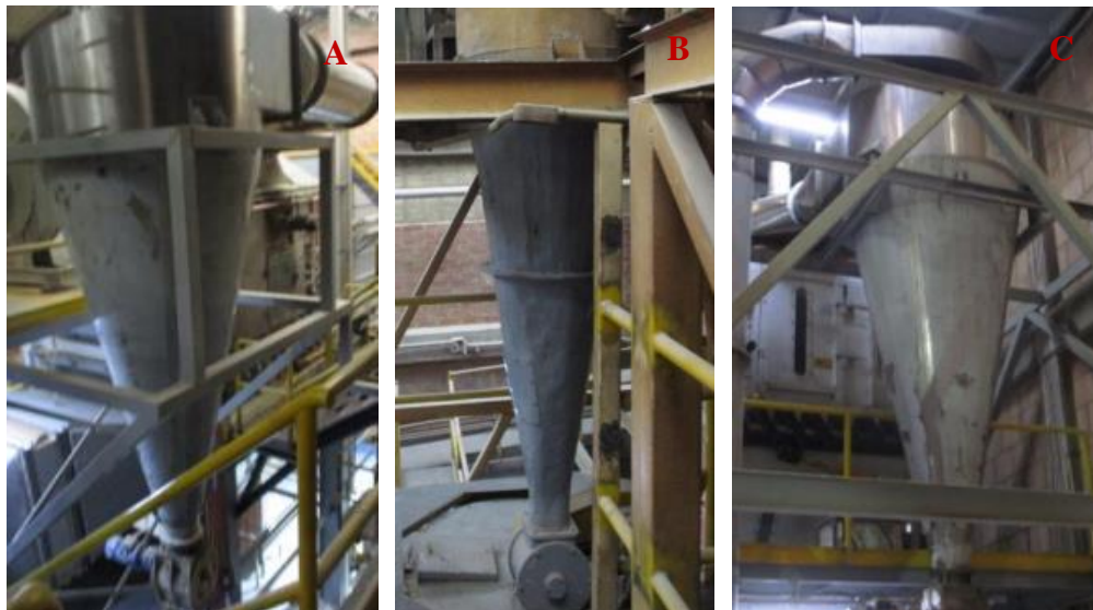
Figura 37. ciclón secador, ciclón cañón de reproceso, ciclón enfriador
