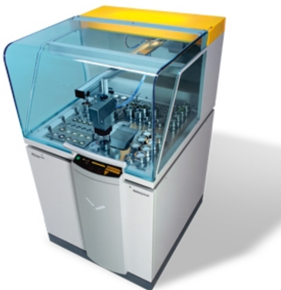
Figura 4.2: Equipo de FRX Axios max de PANalytical. ( http://www.panalytical.com )
