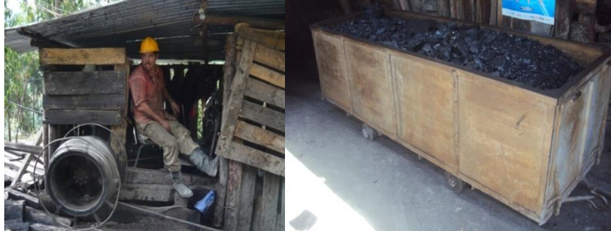
Imagen 7. Sistema de transporte (malacate-vagoneta).
