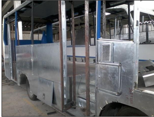
Foto 1. Forrado o laminado exterior de una carrocería
