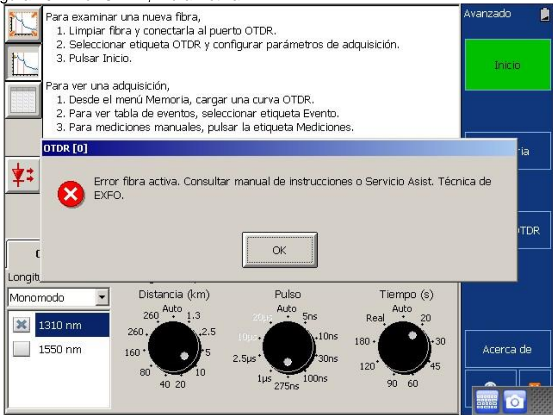
Figura 19. Error OTDR, Fibra Activa
