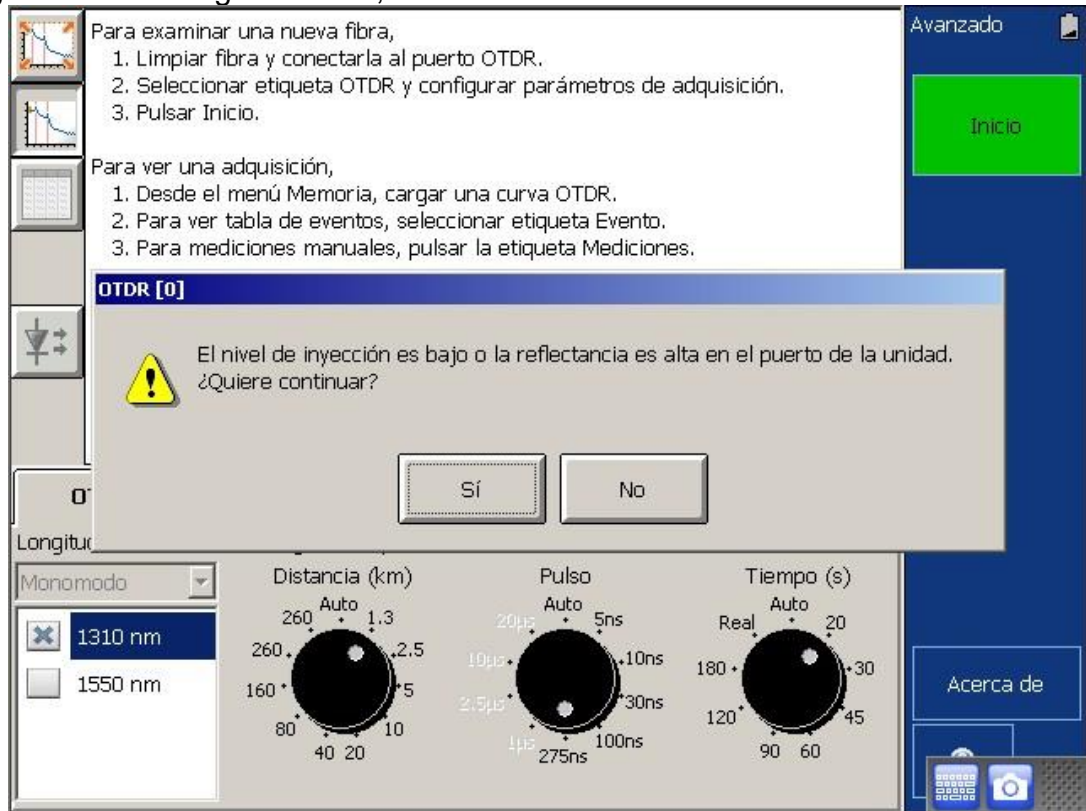
Figura 20. Warning de OTDR, reflectancia alta
