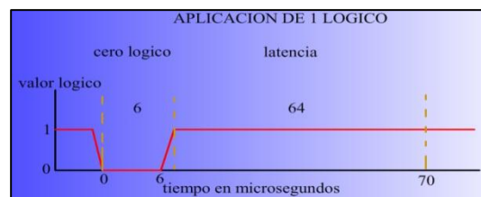
Figura 3.8: Aplicación de 1 lógico con protocolo 1-wire.
