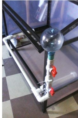
Figura 3.10: Montaje utilizado para los actuadores de humedad.
