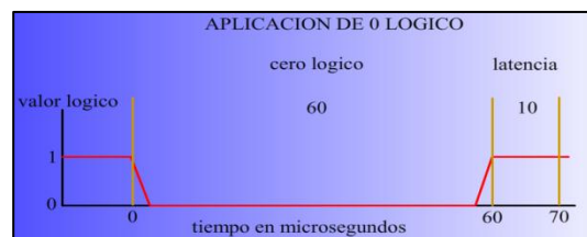
Figura 3.9: Aplicación de 0 lógico con protocolo 1-wire.
