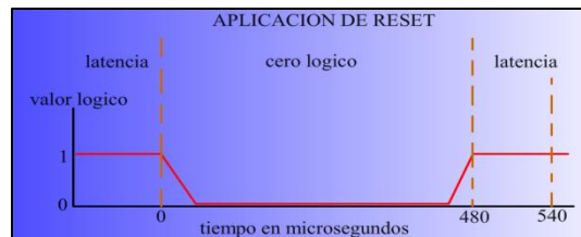
Figura 3.7: Aplicación del pulso de reinicio para dispositivos con protocolo 1-wire.
