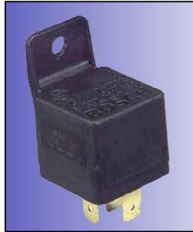
Figura 3.27: Relé BOSCH utilizado para manejar los actuadores de temperatura.
